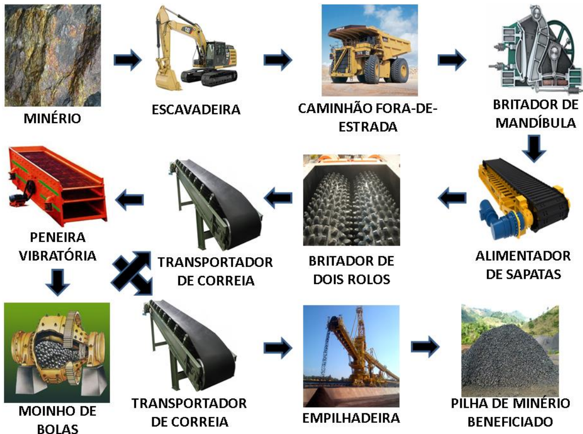
Figura 2: Alguns equipamentos que participam do processo de tratamento/beneficiamento de minério.
