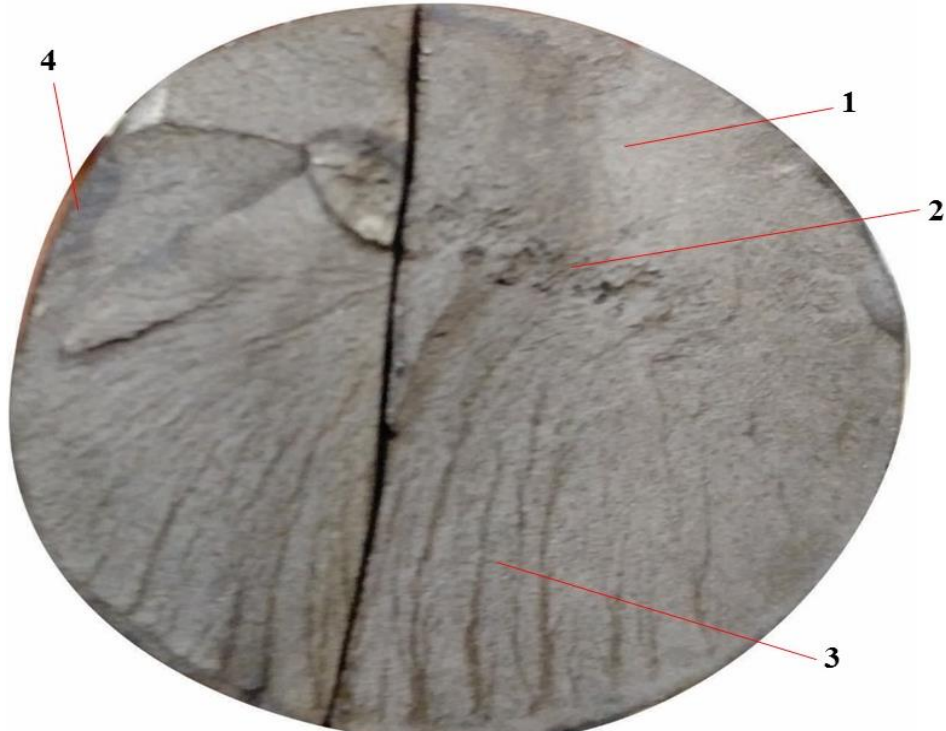
Figura 36: Superfície da fratura do parafuso 2.
