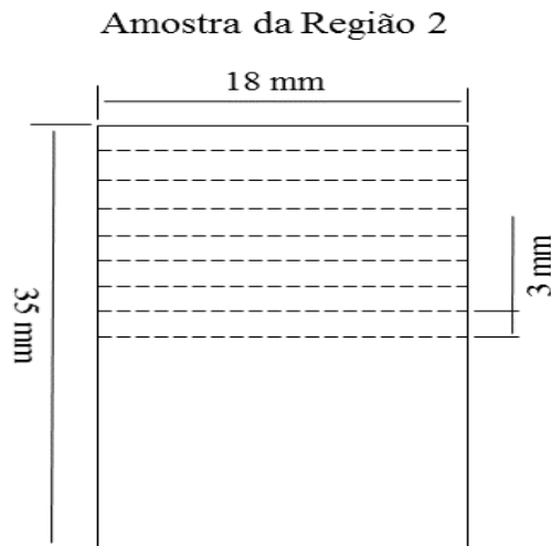
Figura 23: Esquema para a realização do mapeamento de dureza.
