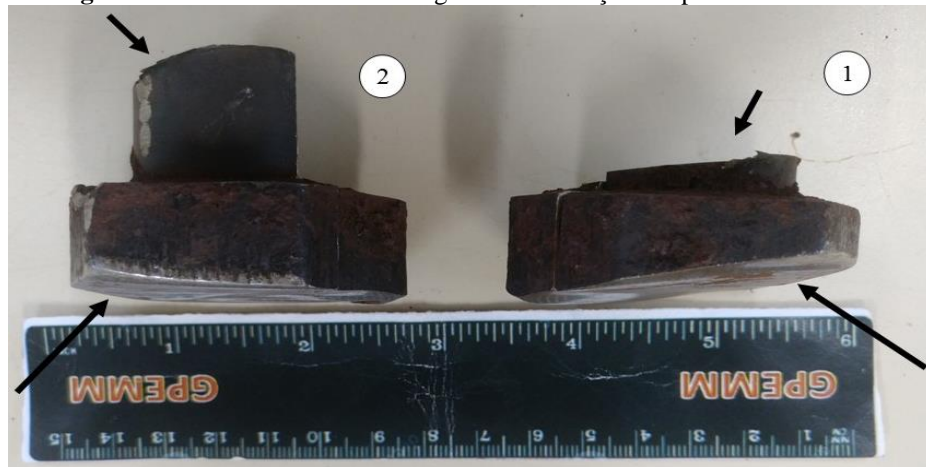
Figura 28: Fratura nas hastes e desgastes nas cabeças dos parafusos.
