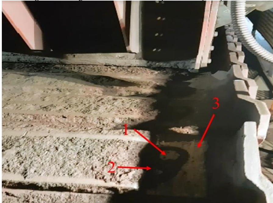
Figura 39: Desgastes encontrados nas sapatas e cabeça do parafuso.
