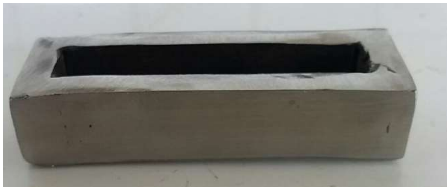
Figura 24 - Molde confeccionado segundo a norma ASTM E23-94a, tipo Charpy.
