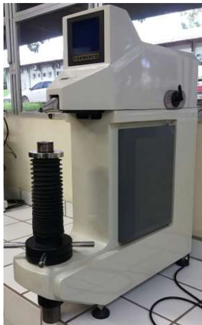
Figura 30 - Durômetro de bancada modelo PANTEC, utilizado para realização do ensaio de dureza Rockwell.
