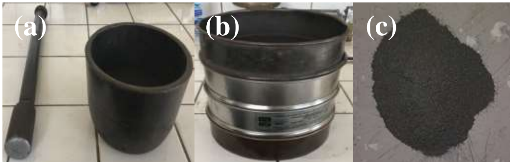
Figura 21 - Preparação da amostra para realizar o DRX. Cadinho (a), pilha de peneiras (b), amostra peneirada em granulometria de 100# ( mesh ).
