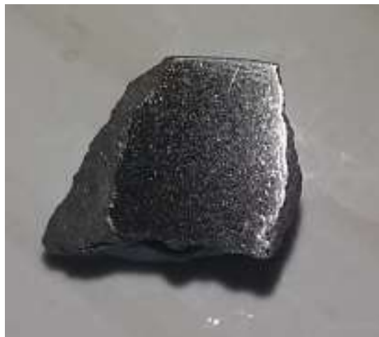
Figura 18 - Amostra polida e atacada quimicamente com nital 5%.
