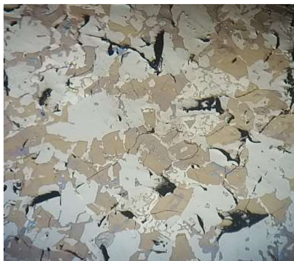
Figura 31 - Micrografia da liga Fe-Si-Mn feita em microscópio ótico com aumento de 10x.
