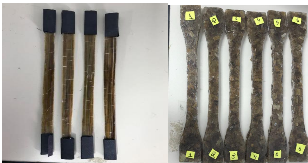
Figura 23 - a) Corpos de provas provenientes da placa prontos para o ensaio de tração b) corpos de prova de 5mm com tratamento químico prontos para ensaio de tração.
