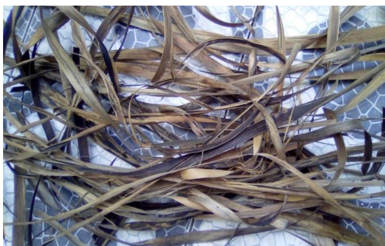
Figura 14 - Fibras separadas da casca antes da normalização.
