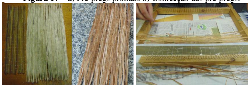
Figura 17 – a) Pré-pregs prontas. b) Confeção das pré-pregs.
