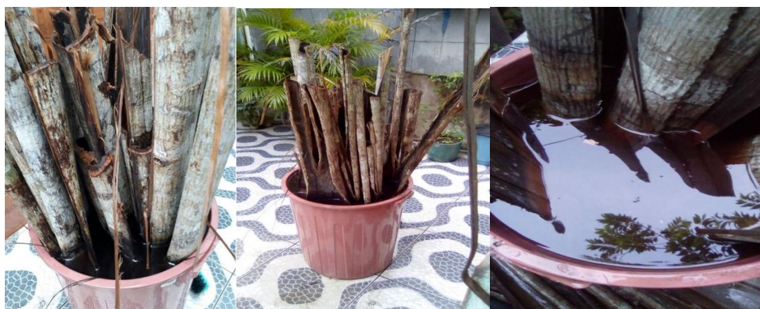
Figura 12 - Fibras de Algodão Brabo submersas na água.
