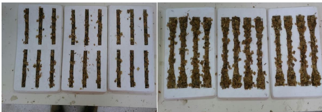
Figura 19 - a) Teste de volume para norma D5942 b) Teste de volume para norma D638.
