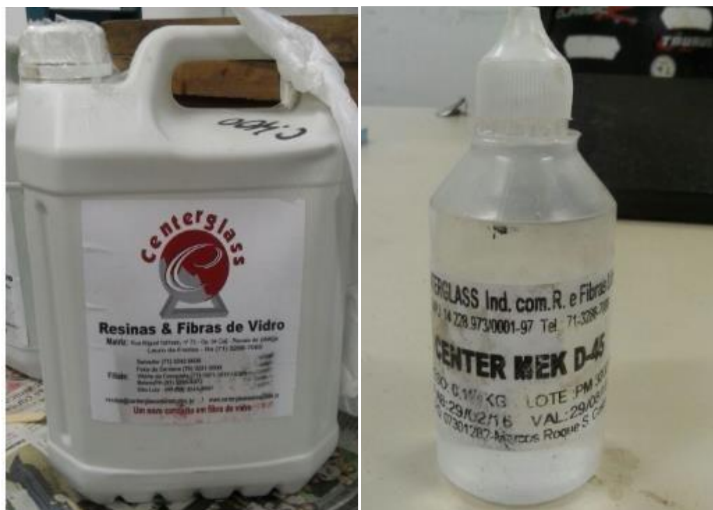
Figura 6 - a) Resina Poliéster Isoftálica; b) Catalisador MEK - D45.
