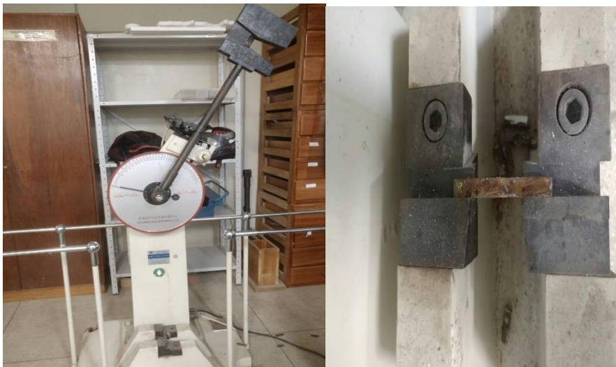
Figura 21 - a) Ensaio de Impacto b) Corpo de Prova.
