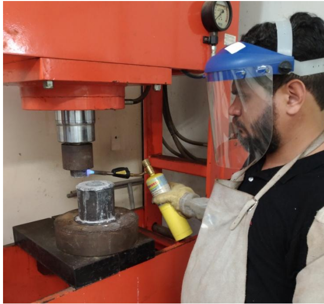
Figura 9 - Etapa de aquecimento da punção da prensa até 100° C com o maçarico.
