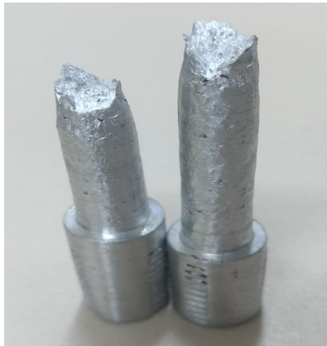
Figura 31 - Característica da fratura tipo de fratura observada no corpo de prova.
