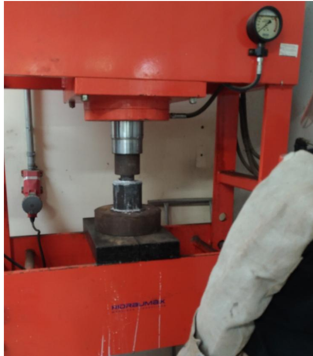
Figura 11 - Atividade de aplicação de pressão (100 MPa) sobre a liga fundida.
