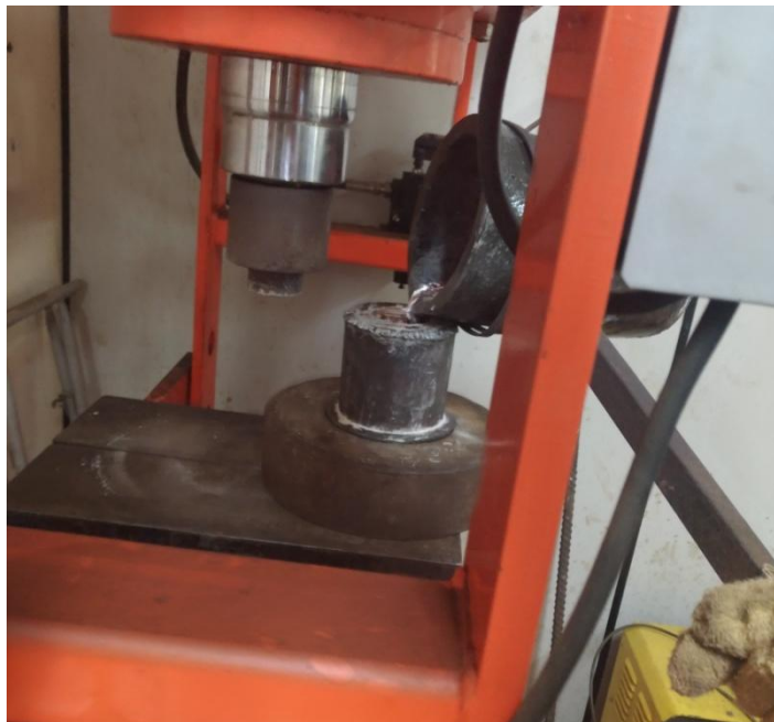
Figura 10 - Processo de vazamento da liga metálica diretamente na lingoteira.
