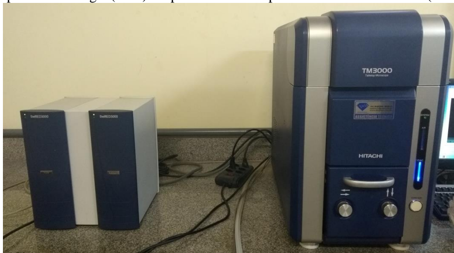
Figura 15 – Equipamentos utilizados na caracterização morfológica da PANi, espectroscopia de dispersão de energia (EDS) acoplado a microscópio eletrônico de varredura (MEV).
