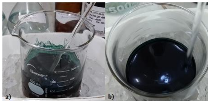
Figura 21 – Mudança na coloração de (a) sal de esmeraldina, verde, para (b) base esmeraldina, azul.
