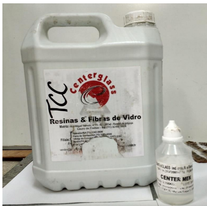
Figura 7- Catalisador MEK - D45 e Resina Poliéster Isoftálica.
