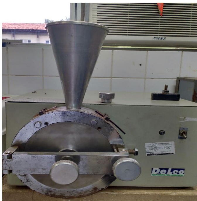
Figura 10 - Moinho de Facas utilizado para a cominuição das fibras
