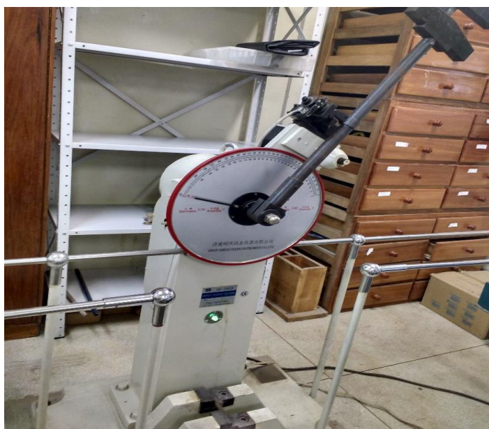
Figura 20- Máquina semiautomática de tenacidade ao impacto, modelo JB - 300B Charpy
