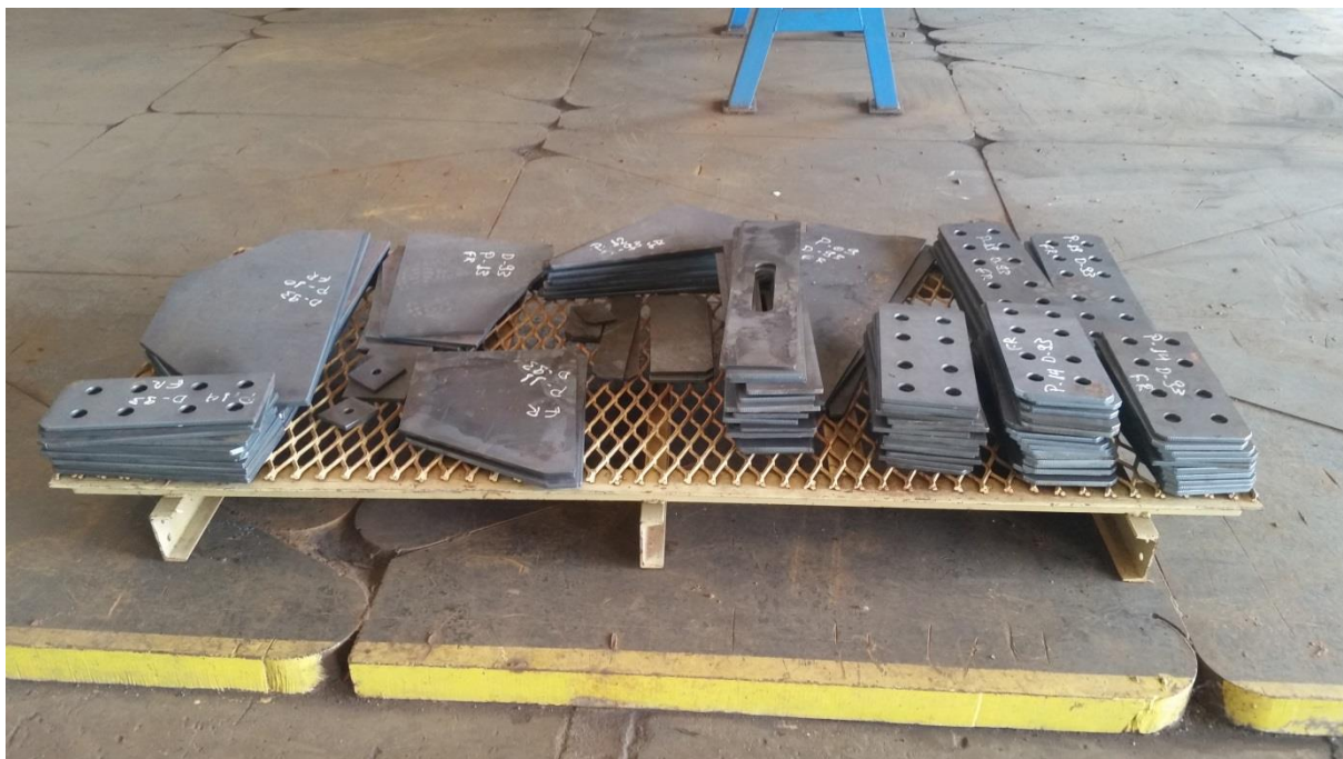
Figura 8: Marcação e inspeção dos itens a serem montados.
