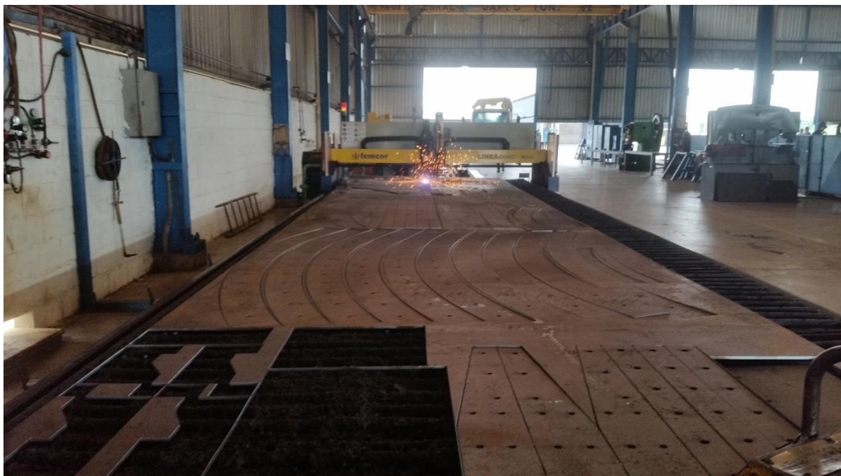
Figura 7: Execução do plano de corte através do corte a plasma CNC.
