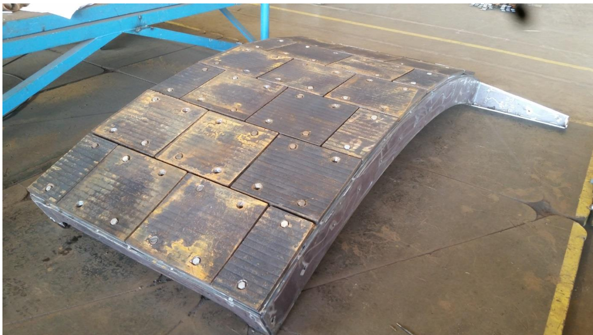
Figura 12: Pré-montagem do revestimento CDP.
