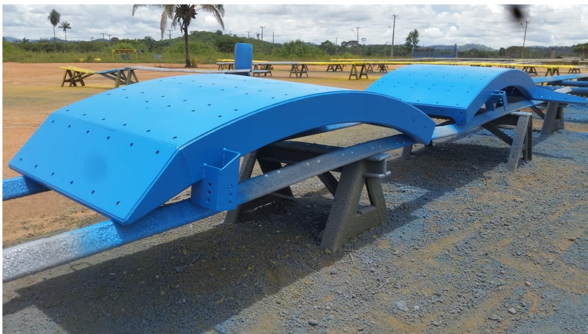
Figura 17: Chute Circular inferior após a pintura com tinta Epoxi Azul Munsell.
