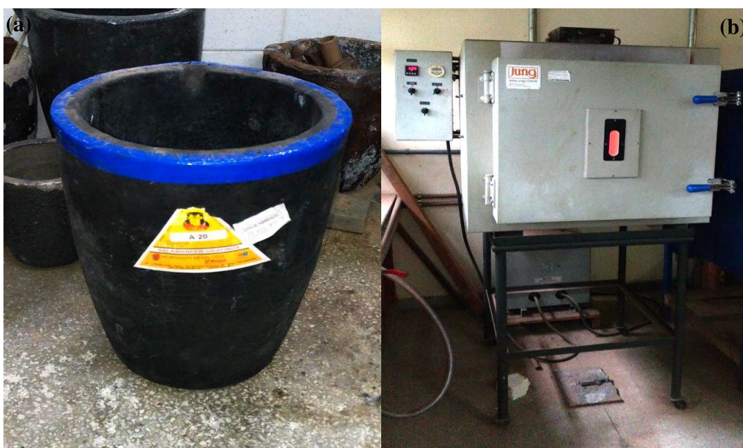
Figura 18- (a) Cadinho de carbeto de silício e (b) Forno elétrico utilizado na fusão das ligas.
