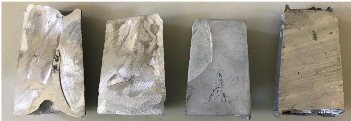
Figura 24- Lingotes cortados ao meio longitudinalmente em ordem crescente de pressão (sem pressão, 80, 120 e 160 MPa).
