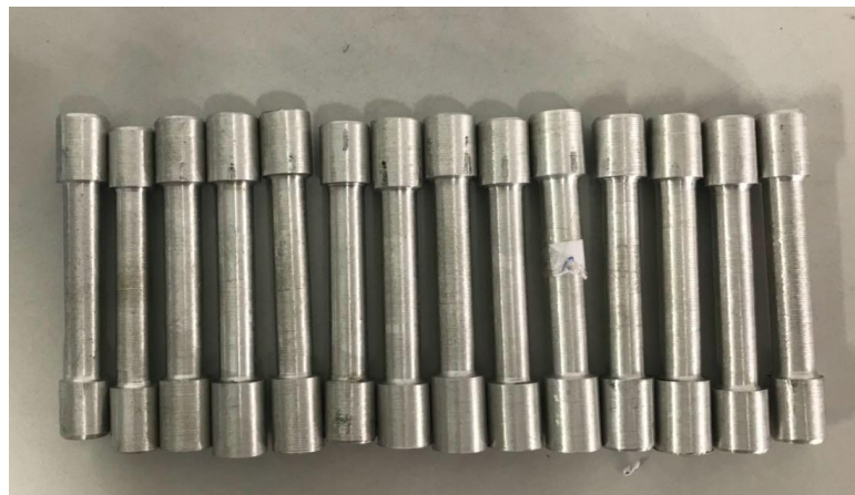
Figura 27- Corpos de prova utilizados no ensaio de tração conforme a norma ASTM E 8M.
