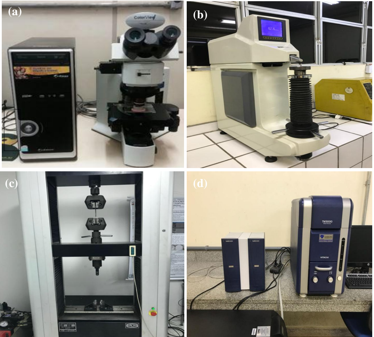
Figura 20- (a) Microscópio óptico com interface digital, (b) Microduromêtro (c), Máquina de Ensaio mecânicos e (d) EDS.
