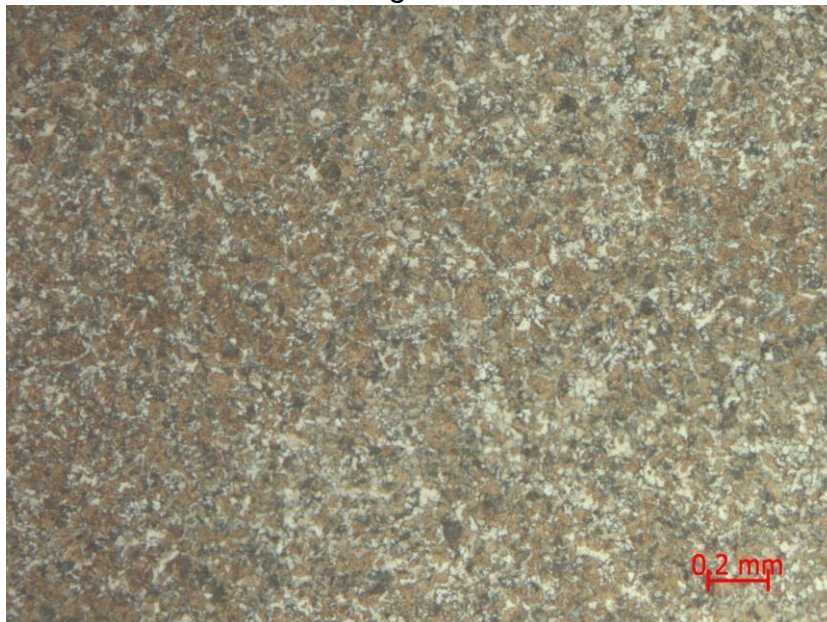
Figura 23 - Microestrutura do aço SAE 1070 submetido a têmpera seguida de revenido a 260°C em óleo natural de girassol. Aumento de 200x. Ataque: Nital 2%
