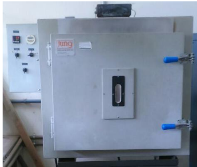
Figura 13 - Forno mufla utilizado para austenitização das amostras
