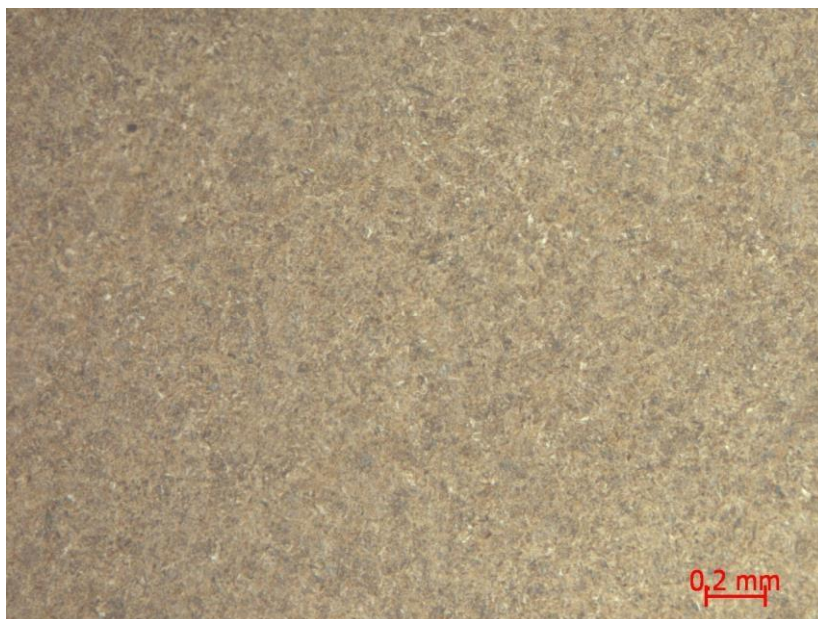
Figura 19 - Microestrutura do aço SAE 1070 submetido a têmpera em água seguida de revenido. Aumento de 200x. Ataque: Nital 2%
