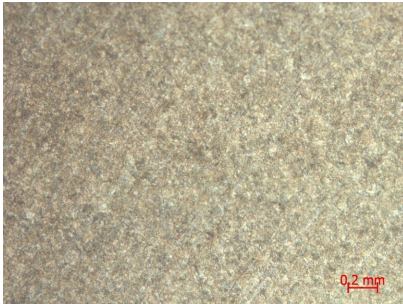
Figura 18 - Microestrutura do aço SAE 1070 resfriado em água. As áreas brancas são de austenita retida. Aumento de 200x. Ataque: Nital 2%.
