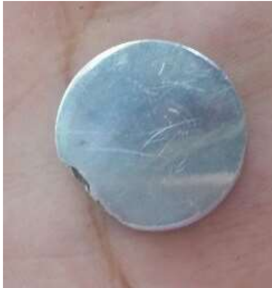
Figura 16: Amostra para metalografia e dureza da liga Al-Mg.
