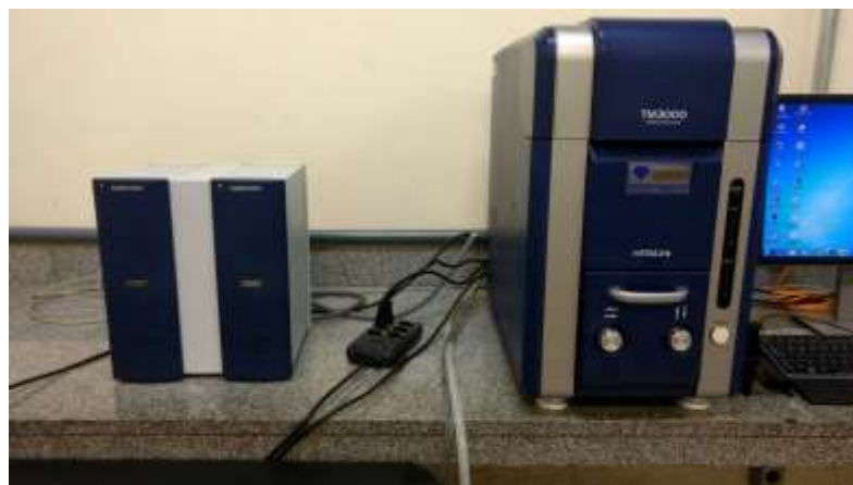
Figura 18: Microscópio Eletrônico de Varredura (MEV) Modelo HITACHI TM 3000 e aceleração de voltagem de 15KV com EDS (Energy Dispersive X – ray Spectrometry) Modelo SwiftED3000 acoplado.
