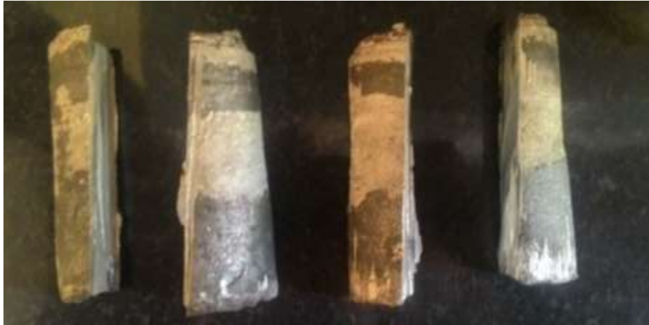
Figura 15: Lingote seccionado para confecção dos corpos de prova.
