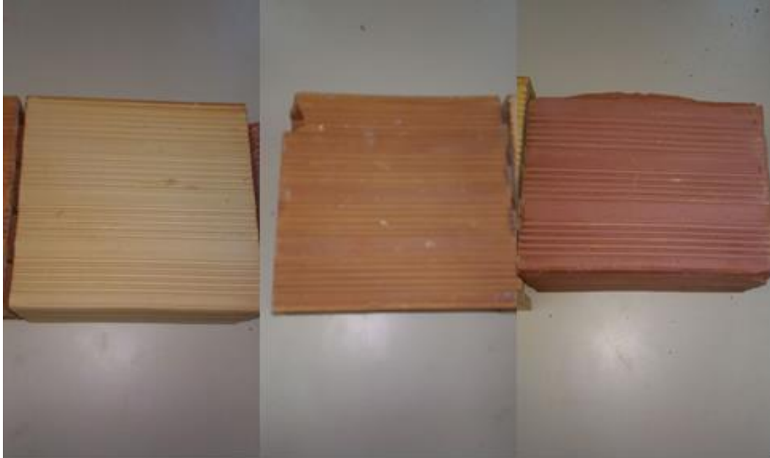
Figura 24. Cores desenvolvidas pelos tijolos após a queima. Esq.: F0; Centro: F1; Dir.: F2.
