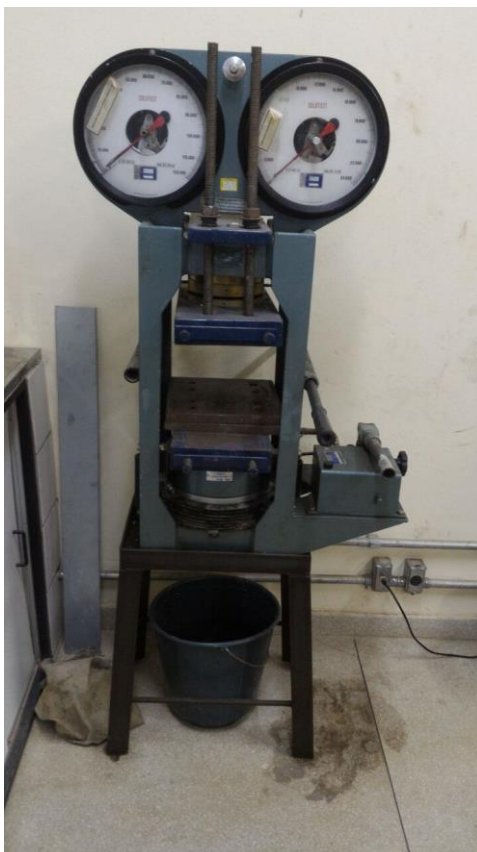
Figura 9. Prensa manual utilizada nos ensaios de compressão.
