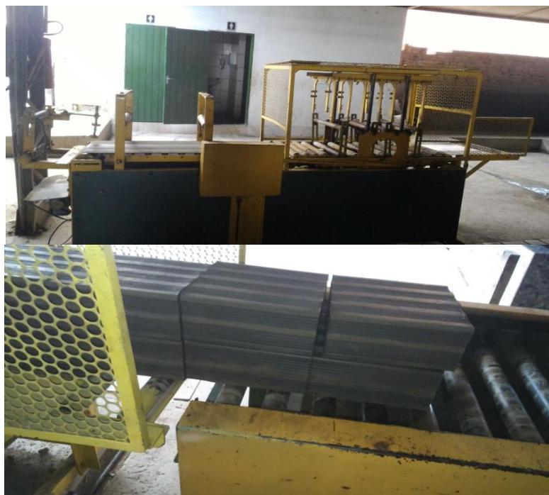
Figura 1. Cima: Visão geral de uma maromba. Baixo: Blocos verdes sendo retirados após a extrusão.
