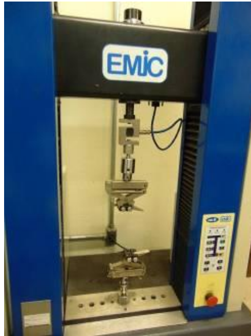
Figura 47: Máquina universal de ensaios EMIC, modelo DL - 10.000
