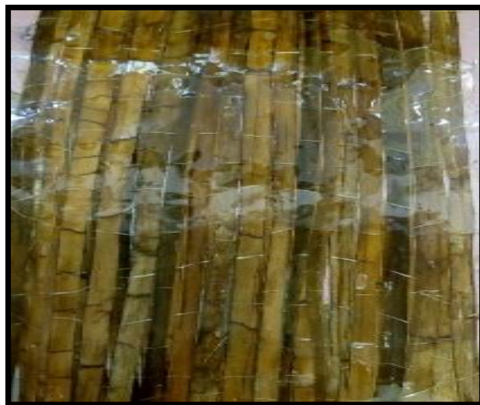
Figura 43: Placa de compósito de Algodão Brabo com resina de poliéster, pronta após uma semana de cura.
