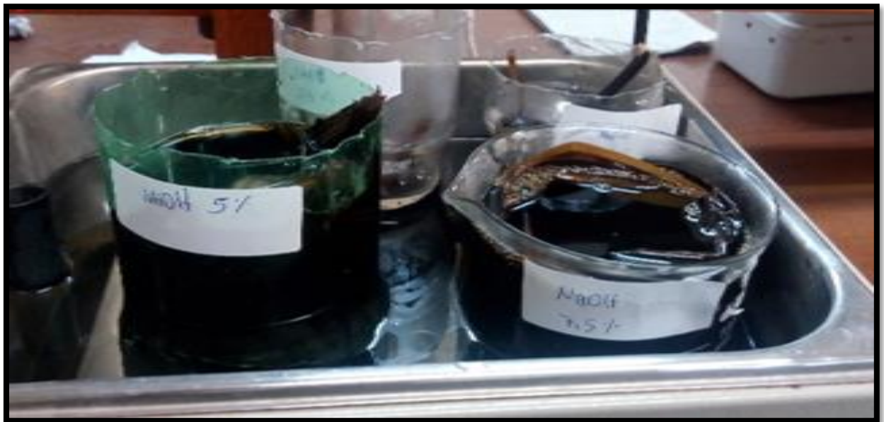
Figura 35: Fibras em seus recipientes com suas respectivas soluções de NaOH em várias concentrações, banho-maria.
