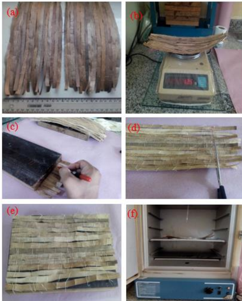
Figura 37: (a), (b), (c), (d), (e) e (f). Procedimento de ajuste e pesagem das pré-pregs de fibras.
