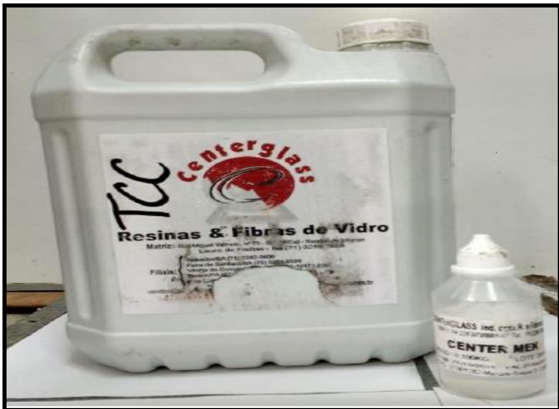
Figura 28: Catalisador MEK - D45 e Resina Poliéster Isoftálica.
