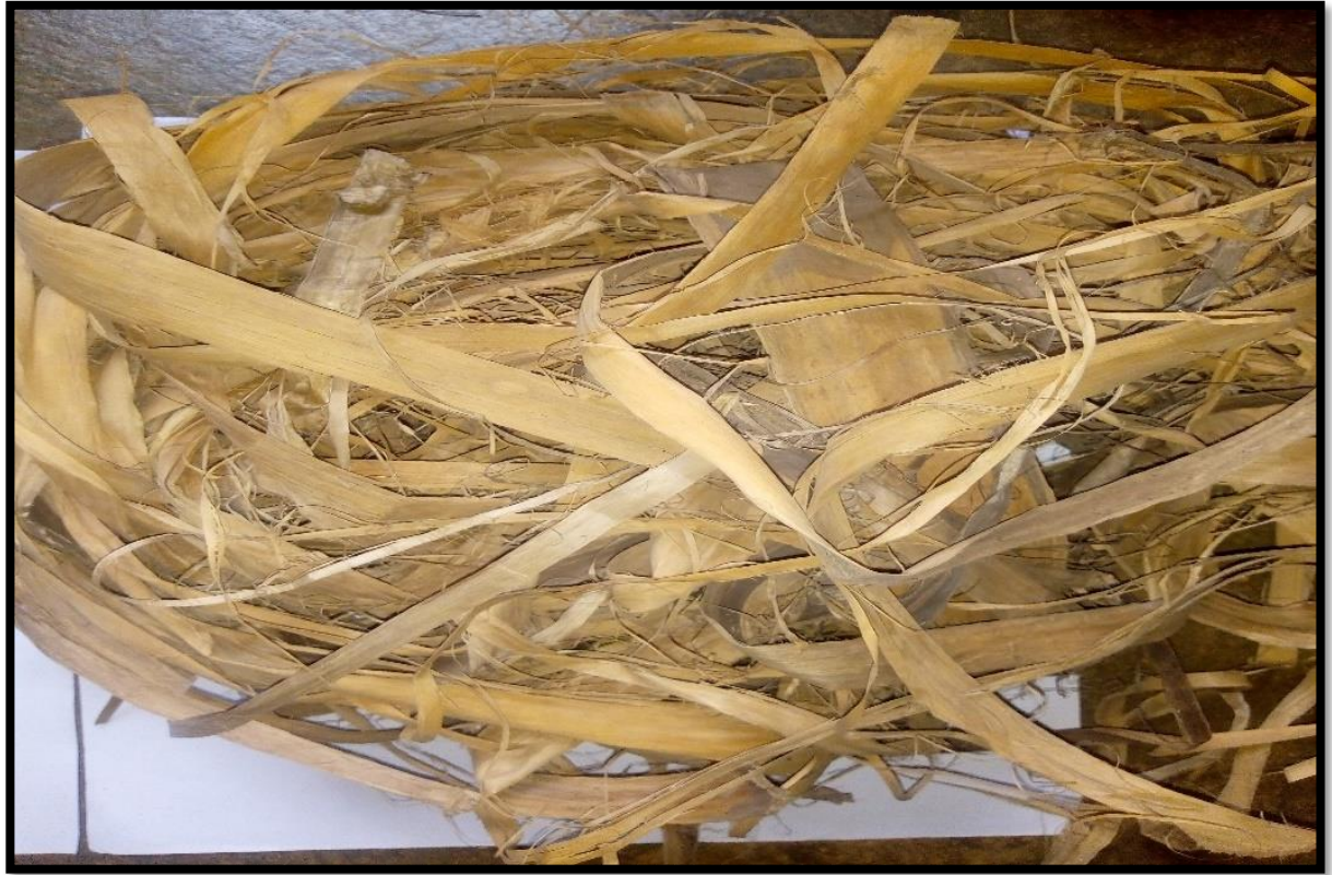
Figura 31: fibras de algodão brabo extraída do caule após 10 dias descansando em água.
