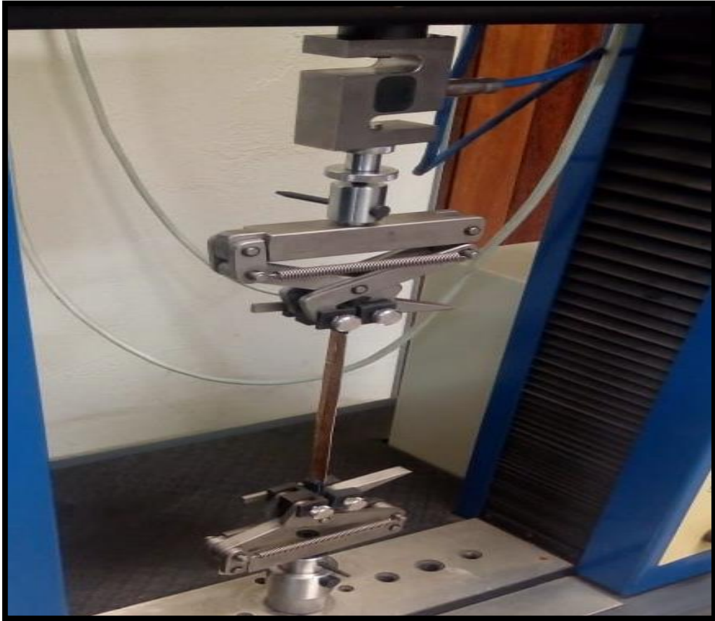
Figura 49: Aparato experimental para o ensaio de materiais compósitos, célula de carga de 5kN.
