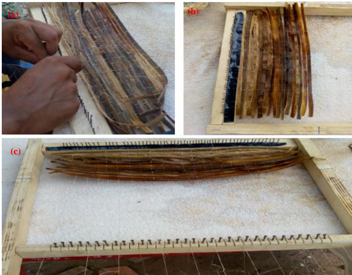
Figura 36: (a) amarração da manta, (b) manta pronta e (c) tamanho da manta usual.
