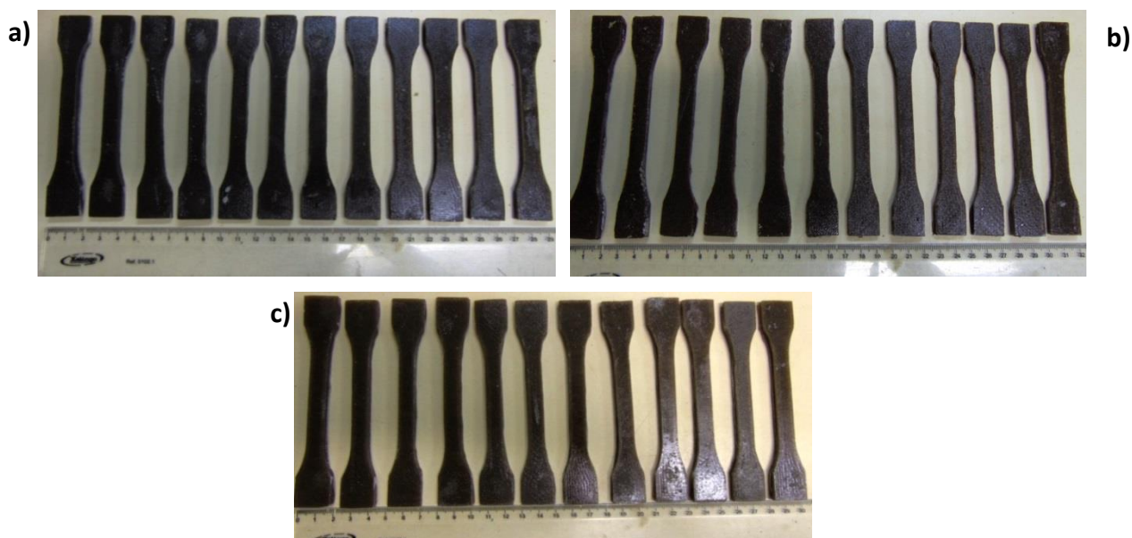
Figura 28 - Corpos de prova de tração obtidos pelo processo de fabricação. a) Mutamba; b) Pente de Macaco; c) Pindaíba.
