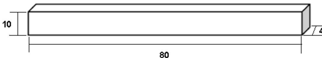
Figura 21 - Dimensões dos corpos de prova de impacto em milímetros.
