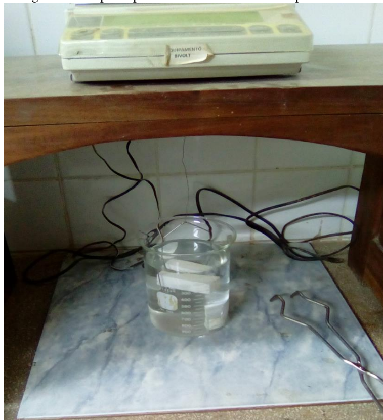
Figura 12: Corpo de prova submetido a medida de peso a úmido.
