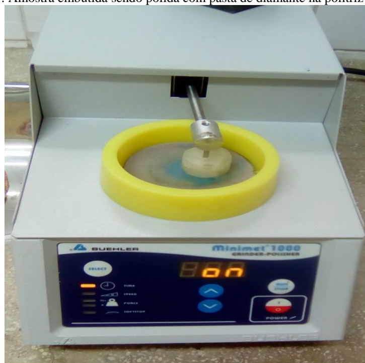
Figura 14: Amostra embutida sendo polida com pasta de diamante na politriz automática
