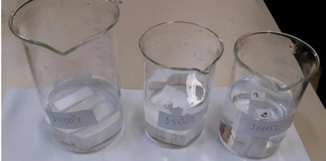
Figura 11: Corpos de prova imersos para realização do método de Arquimedes
