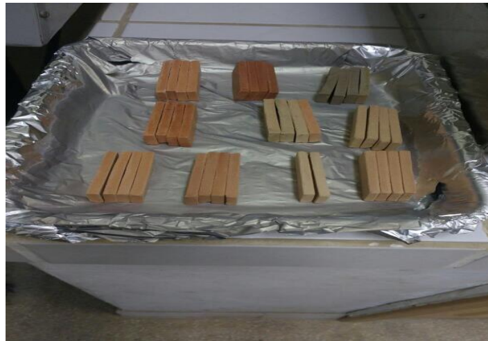
Figura 5 - Formulações(F11-F20) sinterizados a 1000^{\circ}\text{C} .
