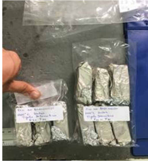
Figura 6 - Formulações (F21- F30) após calcinação e sinterização coberta com papel alumínio.
