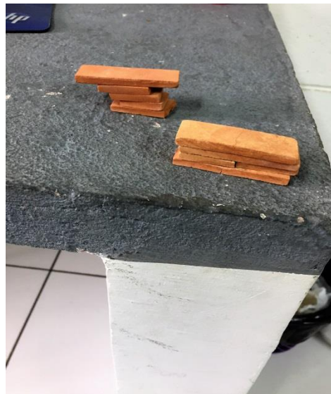
Figura 10 - Corpos de Provas, após o ensaio de Flexão.
