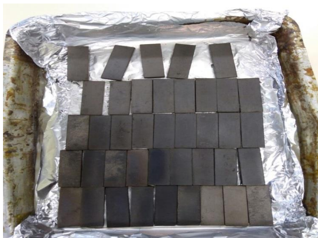
Figura 3 - Formulação (F1-F10) depois de calcinada a 300° C.
