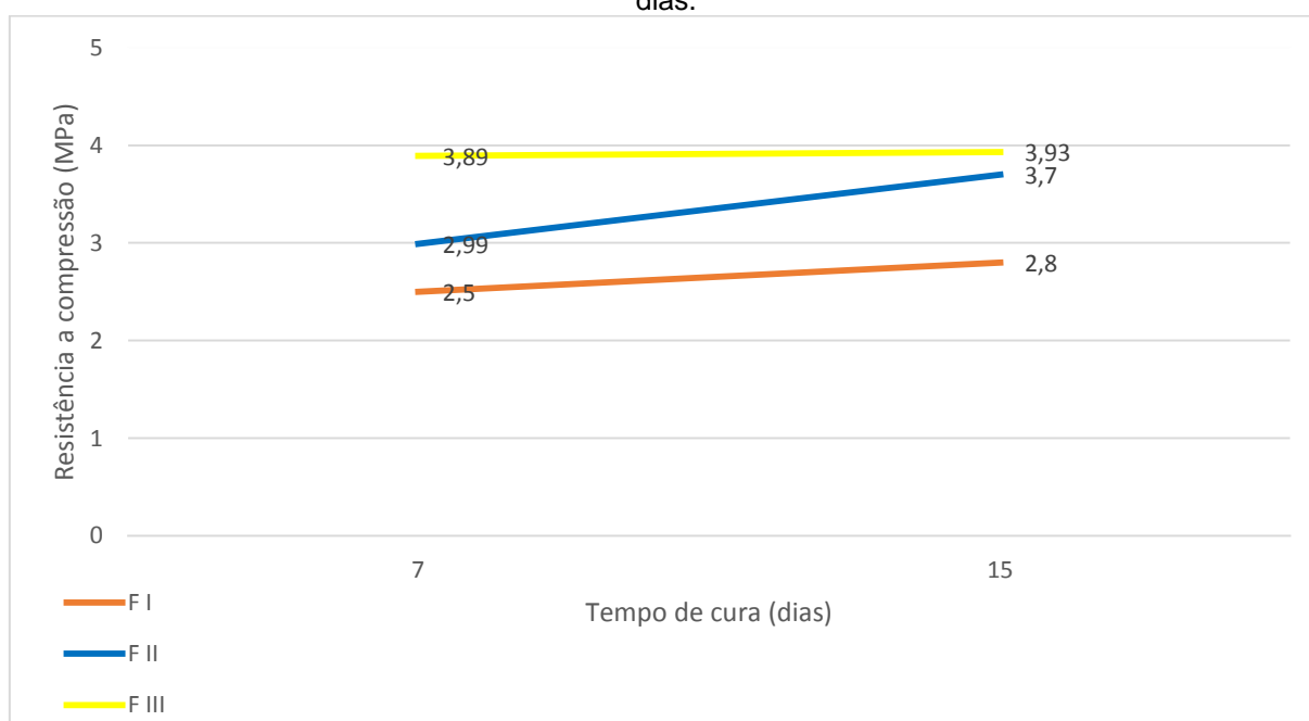
Figura 16: Resultados das resistências à compressão em relação com o tempo de cura de 7 e 15 dias.
