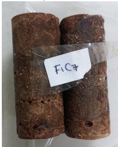
Figura 11: Corpos de prova desmoldados, com 7 dias de cura e 10% de escória de alto forno.
