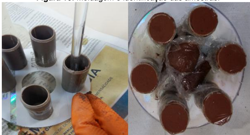
Figura 10: Moldagem e identificação das amostras.
