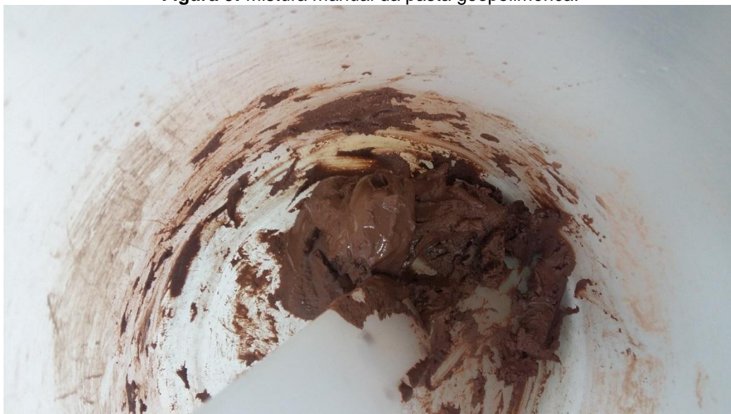
Figura 9: Mistura manual da pasta geopolimérica.
