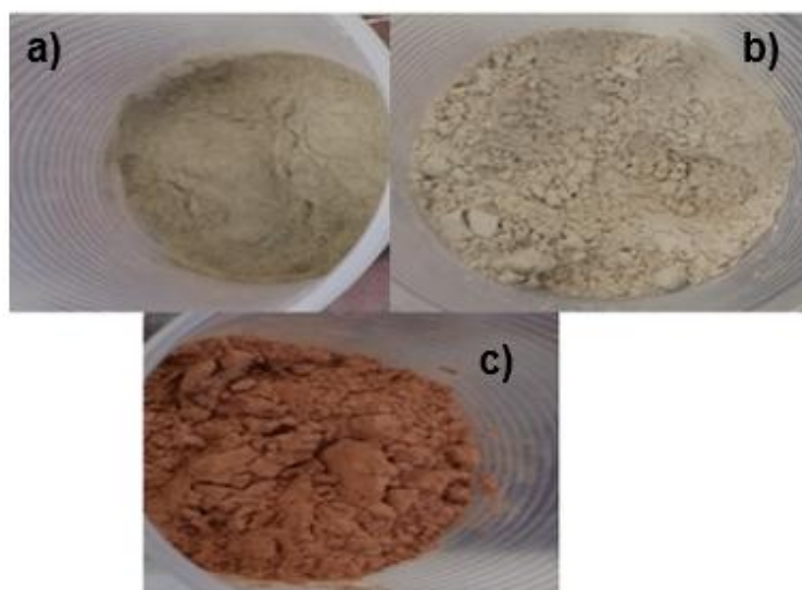
Figura 7: Materia prima solida para a mistura geopolimerica; a) Escória de alto forno; b) Metacaulim; c) Filito.
