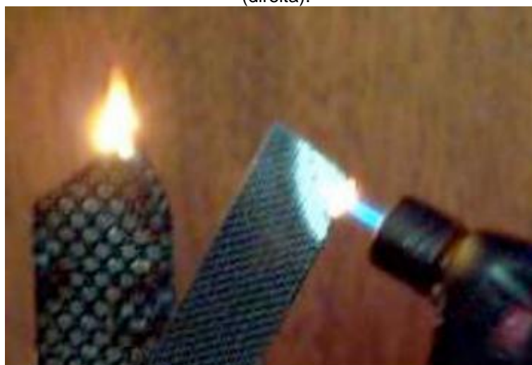
Figura 3: Compósito de epoxi- carbono (esquerda), e um compósito de geopolímero carbono (direita).
