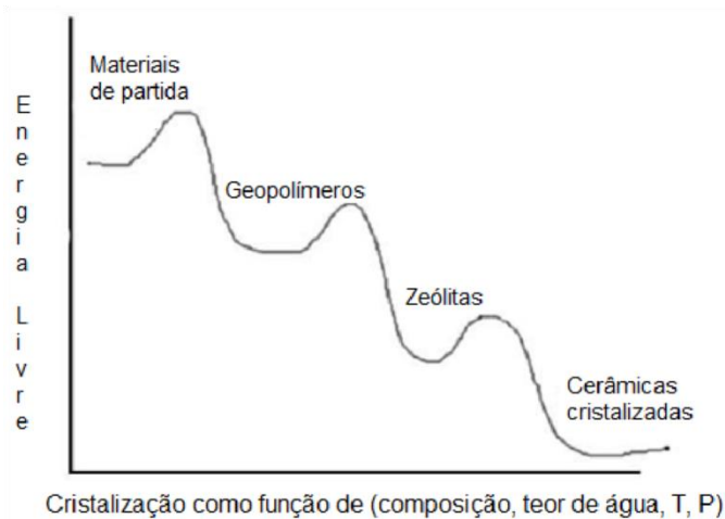
Figura 4 - Diagrama de energia livre que ilustra a relação entre as fases estável e metaestável entre aluminossilicatos relacionados quimicamente.
