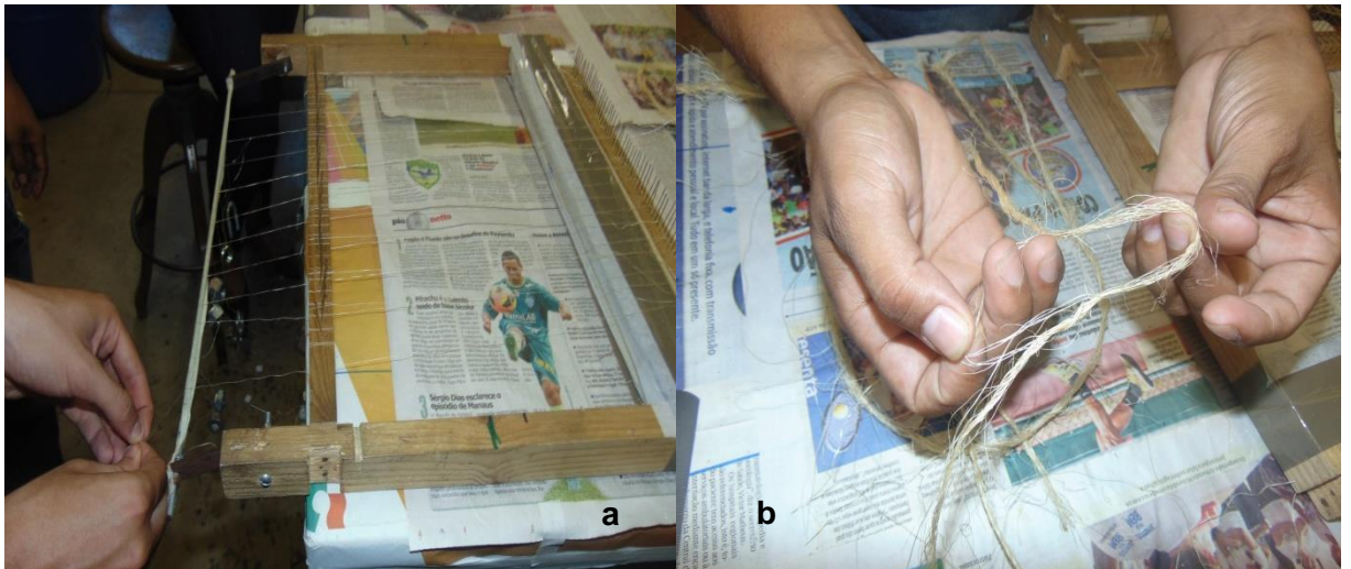
Figura 16: a- Montagem do Tear, b- linha de amarração (Sisal)
