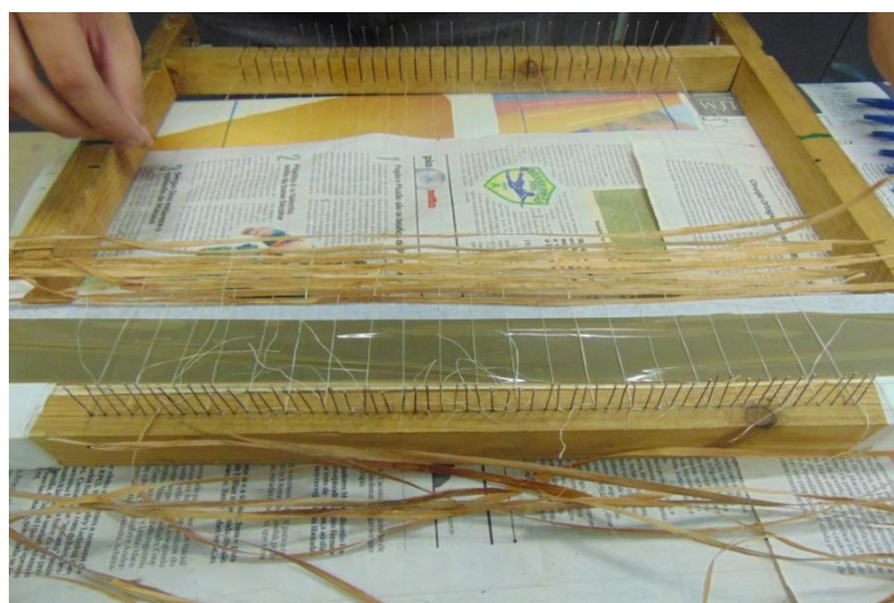
Figura 17: Fabricação da manta de Mutamba no Tear
