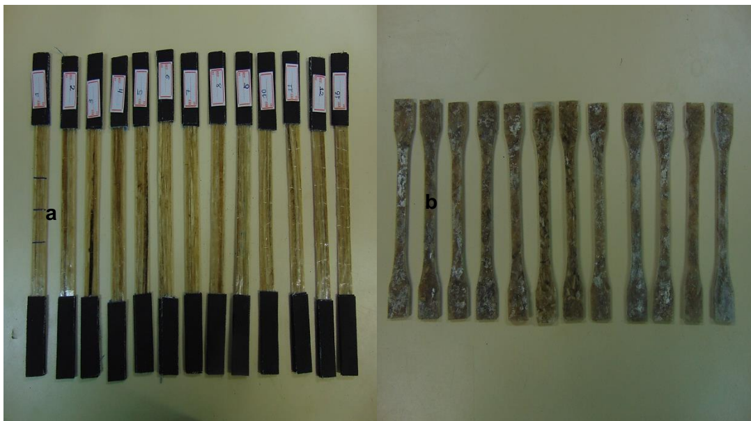
Figura 22: a- Corpos de prova segundo a normal D3039; b- Corpos de prova segundo a norma D638. (Pente de Macaco)
