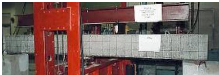
Figura 4: Viga de concreto geopolimérico com camadas de composto de carbono aplicados
