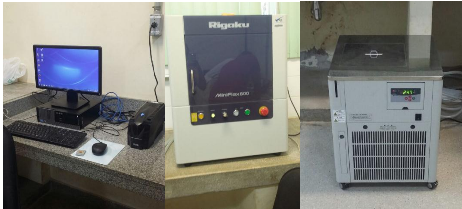
Figura 12: Equipamento usado para a caracterização por DRX
