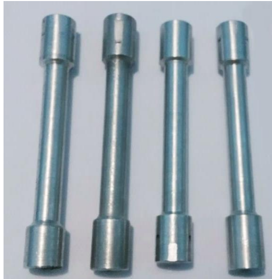
Figura 26: Corpos de prova de ensaio de tração
