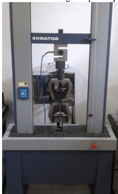
Figura 27: (a) corpo de prova posicionado na máquina de ensaios, (b) Visão aproximada da garra que acopla o corpo de prova.
