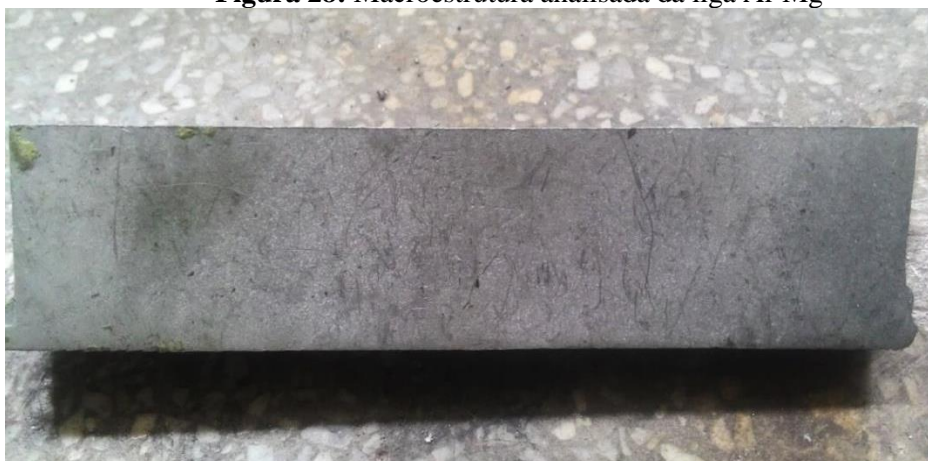
Figura 28: Macroestrutura analisada da liga Al-Mg
