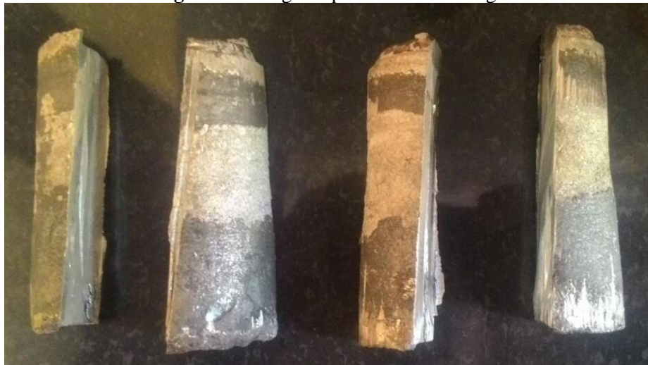
Figura 23: Lingote após dois cortes longitudinais
