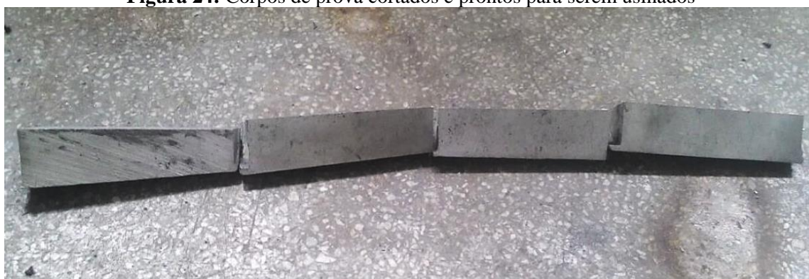
Figura 24: Corpos de prova cortados e prontos para serem usinados
