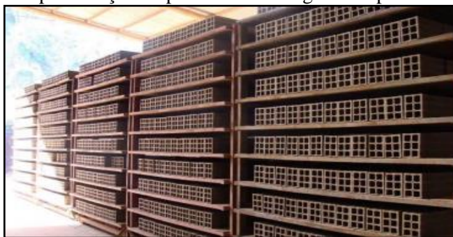
Figura 6: Representação do processo de secagem dos produtos cerâmicos
