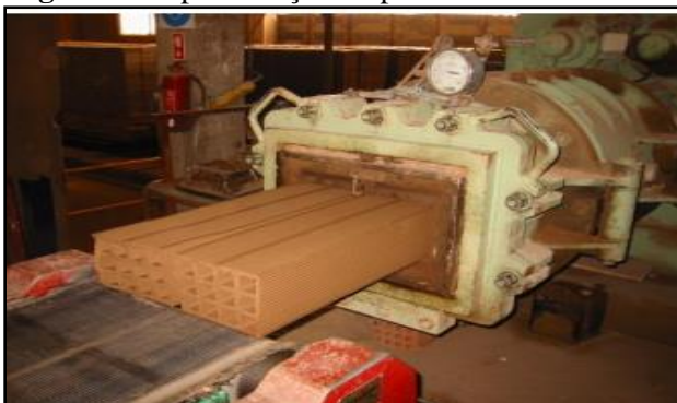
Figura 4: Representação do processo de extrusão
