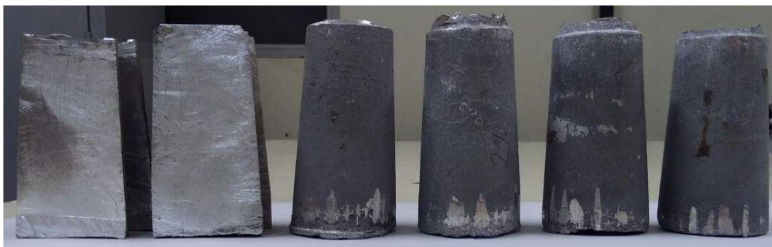
Figura 30 – Lingotes inteiros e visão do corte feito longitudinalmente para usinagem dos corpos de prova.
