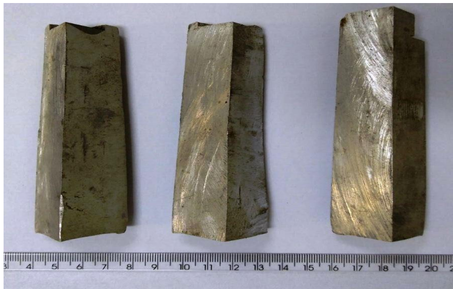
Figura 31 – Corte feito no lingote para confecção dos corpos de prova
