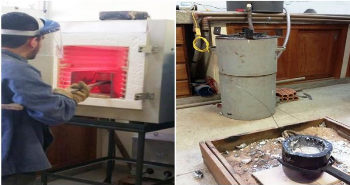
Figura 26 – Entrada do cadinho no forno aquecido e aferimento da temperatura da liga
