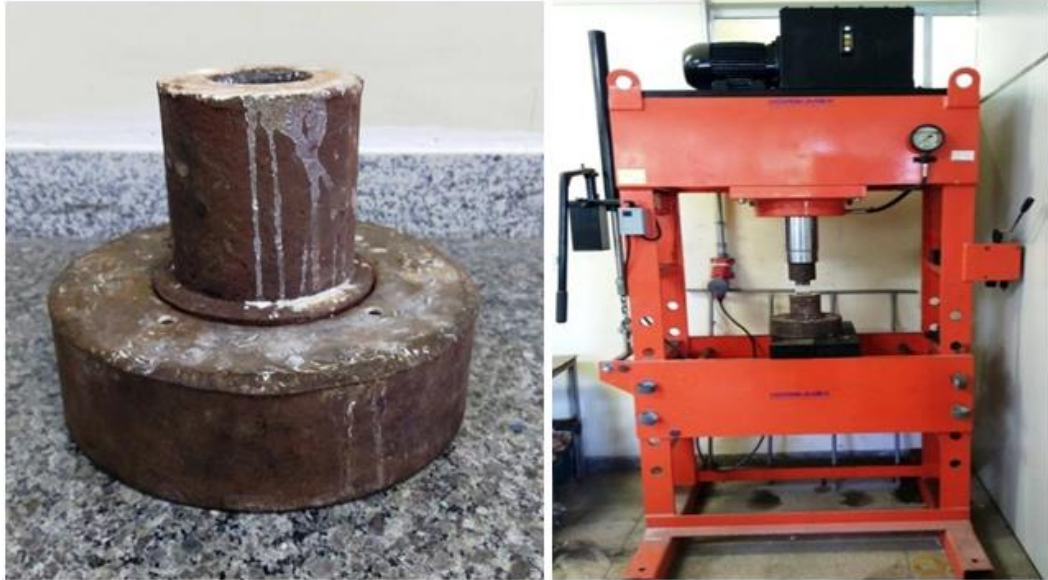
Figura 24 - Perfil da Lingoteira de aço 1045 e Prensa hidráulica semi-automática utilizada
