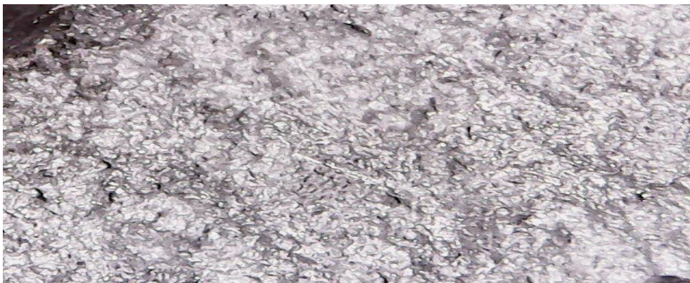
Figura 40 - Imagem da fratura após ensaio de tração, liga com 2% Mg, aumento 1000 X.
