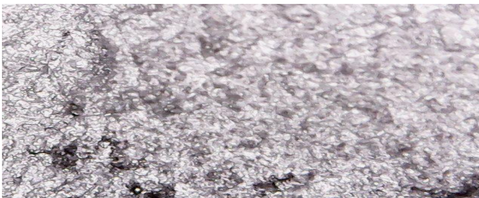
Figura 41 – Imagem da fratura após ensaio de tração, liga com 3% Mg, aumento 1000 X
