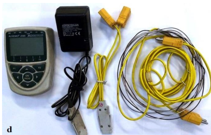
Figura 23 – Sistema de aquisição de dados, plug-conector e haste de Aço ASTM 1045, utilizados no registro das temperaturas envolvidas nos experimentos (d).
