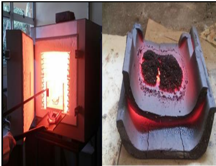
Figura 28 - Amostra de lama vermelha tratada termicamente a 1200 °C, retirada após 60 min
