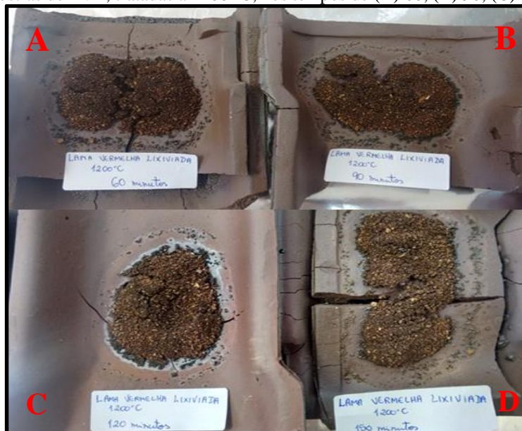
Figura 29 - Amostras de LVL, tratadas a 1200 °C, nos tempos de (A) 60, (B) 90, (C) 120 e (D) 150 min
