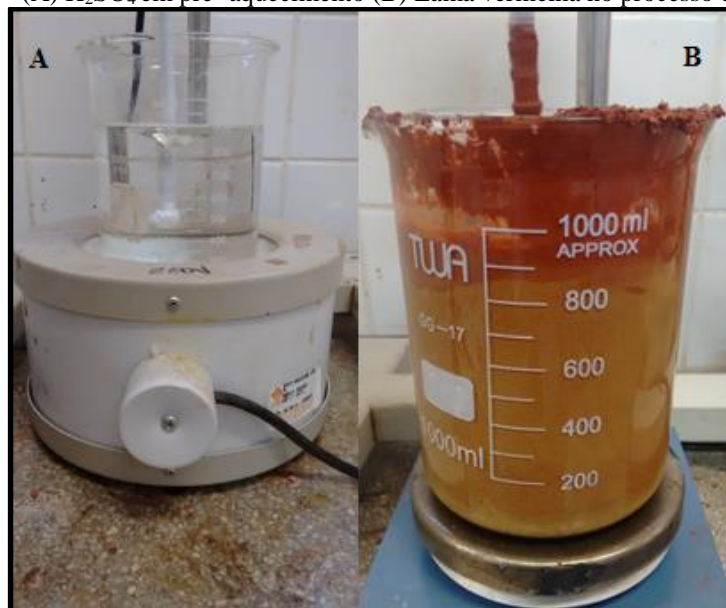
Figura 23 - (A) H_2SO_4 em pré- aquecimento (B) Lama vermelha no processo de lixiviação
