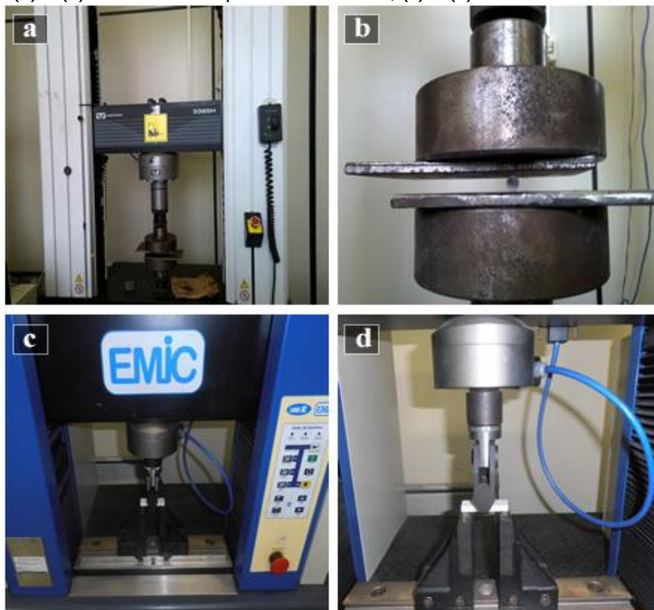
Figura 14: (a) e (b) ensaio de compressão diametral; (c) e (d) ensaio de flexão em 3 pontos.
