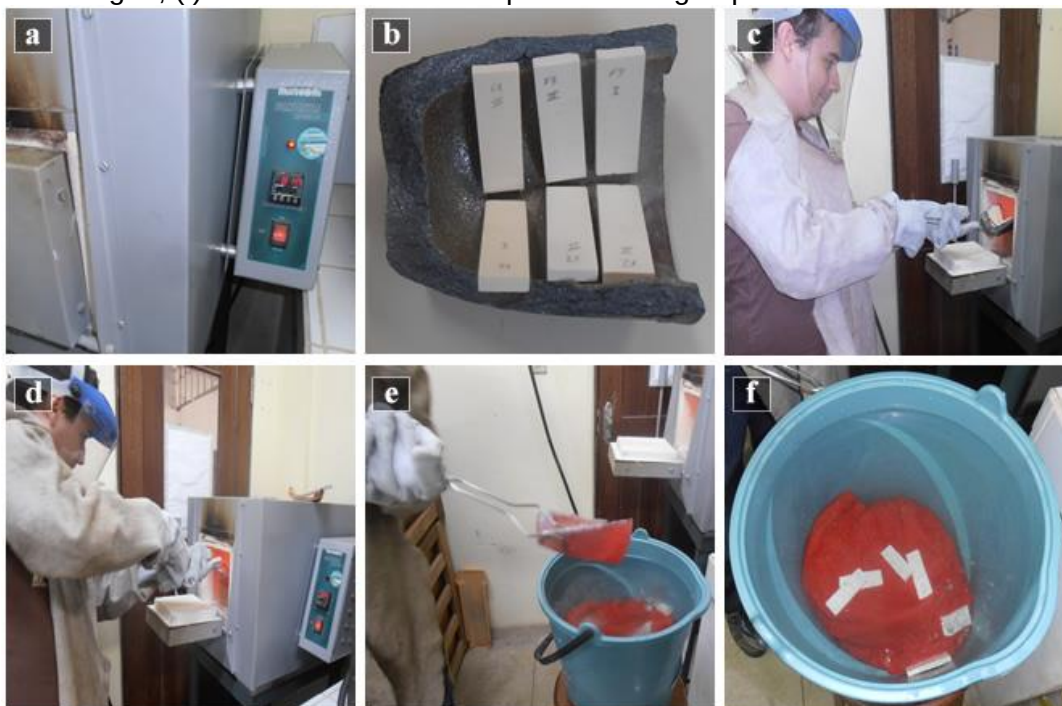
Figura 12: (a) forno mufla utilizado; (b) corpos de prova na base de grafita; (c) inserção da base no interior do forno; (d) retirada da base após 12 minutos; (e) corpos de prova sendo imersos em água; (f) CP's resfriando no recipiente com água por 5 minutos.
