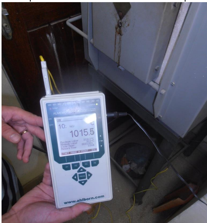
Figura 13: Aferição da temperatura do forno com auxílio de termopar.
