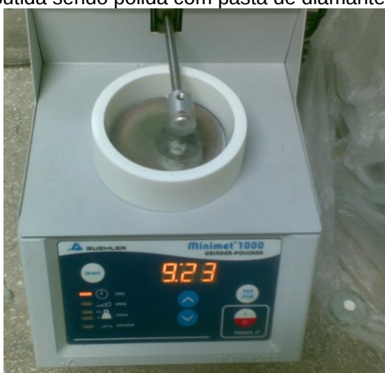
Figura 16: Amostra embutida sendo polida com pasta de diamante em máquina politriz.
