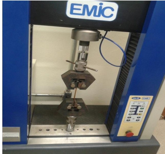
Figura 19 – Ensaio de tração nos corpos de prova.
