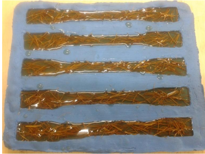
Figura 17 – Molde preenchido com resina e fibras de coco
