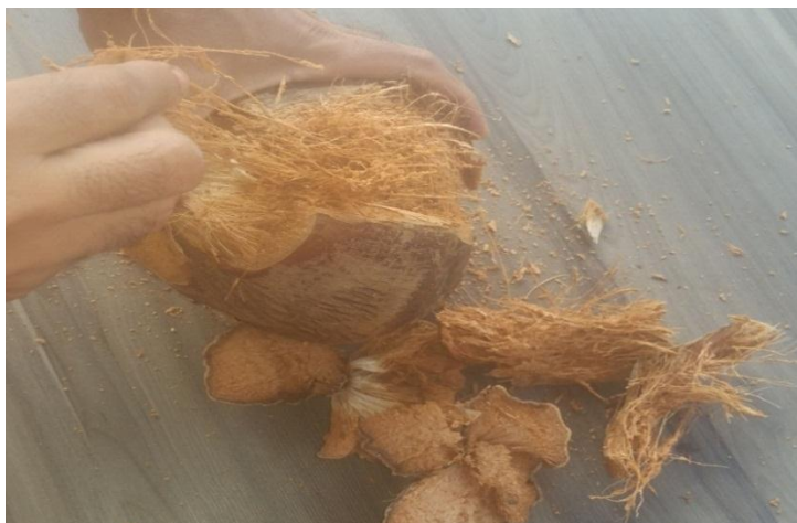
Figura 13 – Desfibramento manual das fibras longas de coco.
