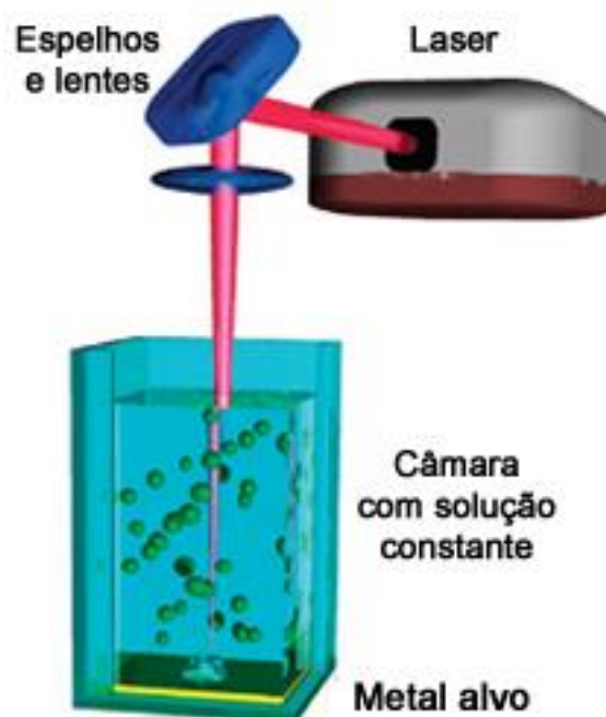
Figura 07 - Exemplo de ablação a laser sem fluxo de solução.
