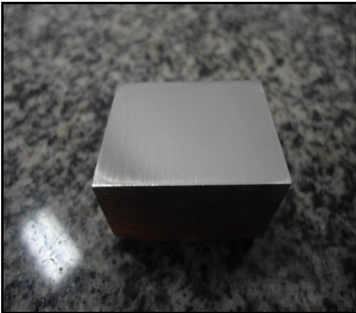
Figura 14 - Amostra para metalografia e dureza do aço SAE 4140.
