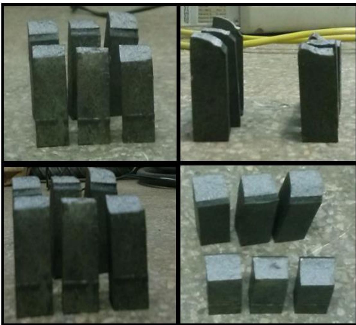
Figura 34 – Amostras de impacto rompidas após ensaio.
