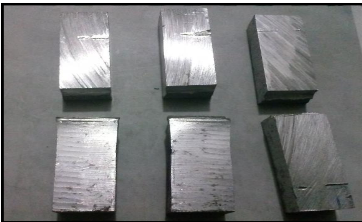
Figura 29 – Amostras de impacto rompidas após ensaio.
