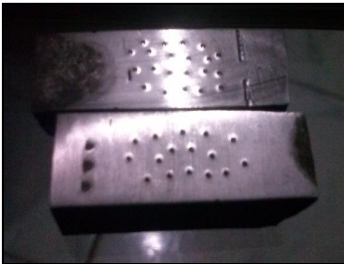
Figura 32 – Análise da dureza em diferentes pontos da peça.
