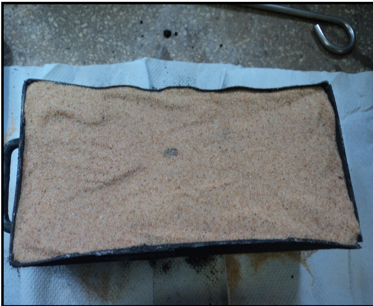
Figura 19 - Peças já cobertas com camadas de coque de injeção e sílica.
