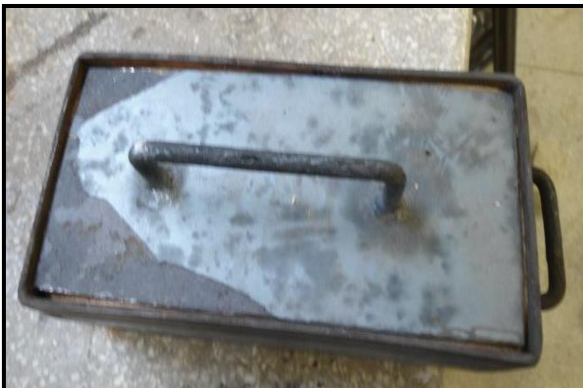
Figura 17 – Caixa metálica utilizada no tratamento.
