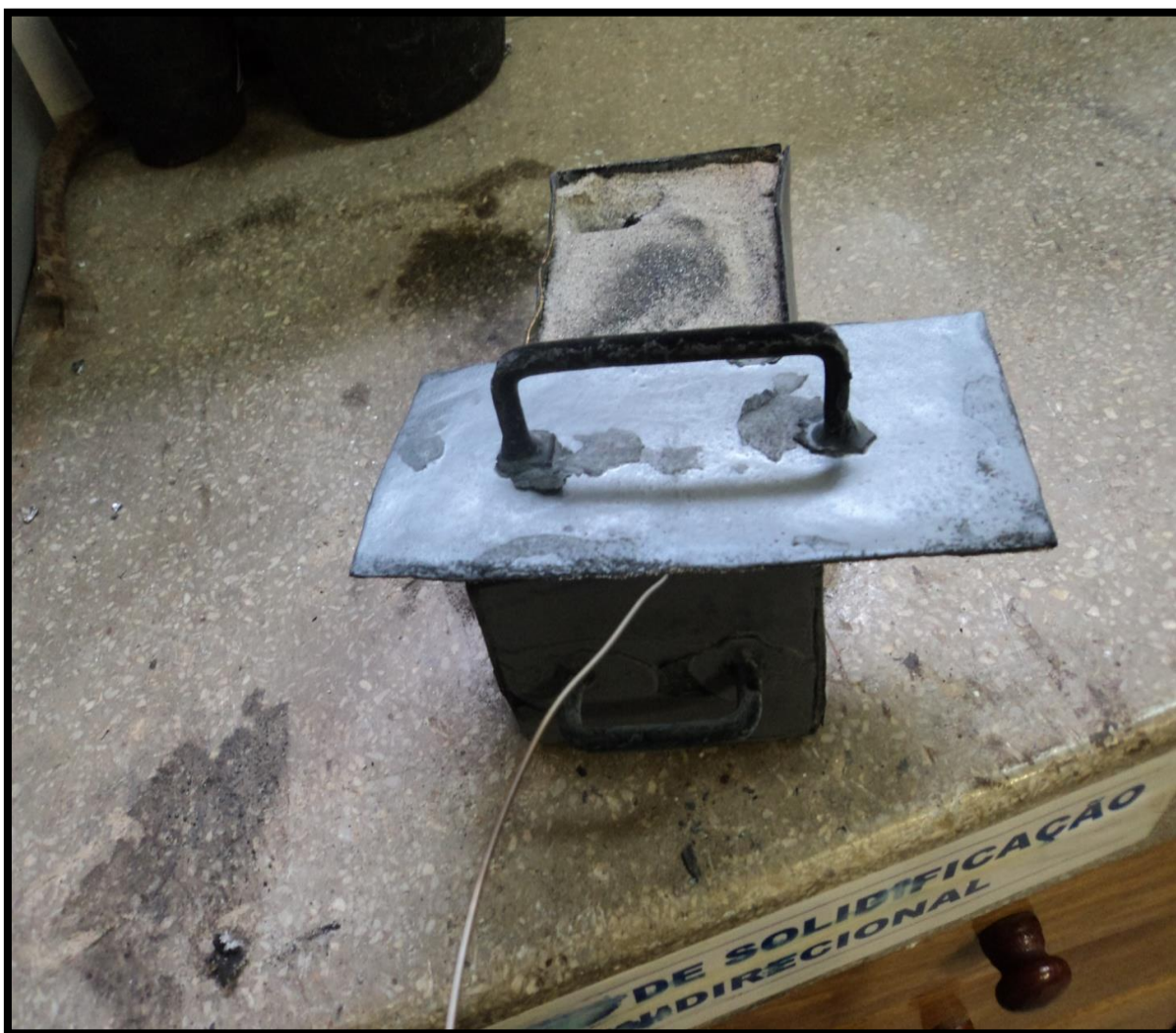
Figura 20 – Controle de temperatura na peça cementada.
