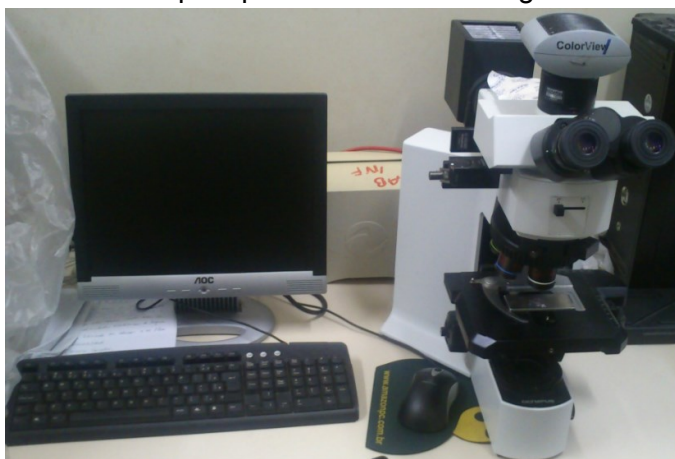
Figura 13 - Microscópio óptico com interface digital
