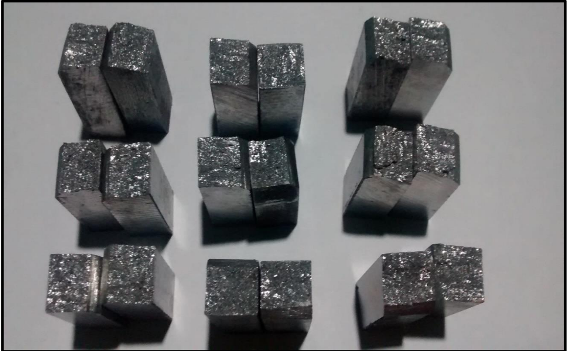
Figura 54 - Fratura observada nos CP's após ensaio de impacto de Charpy.
