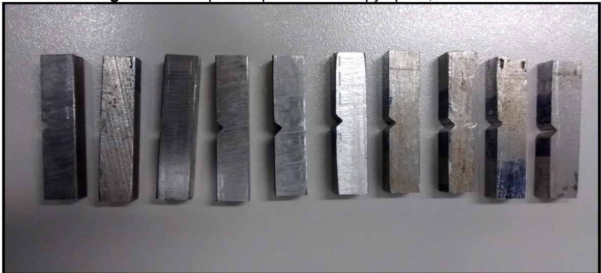
Figura 42 - Corpos de prova de Charpy tipo A, usinados.
