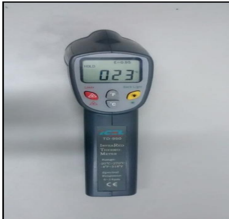
Figura 38 - Termômetro digital infravermelho usado de apoio no controle da temperatura do forno.
