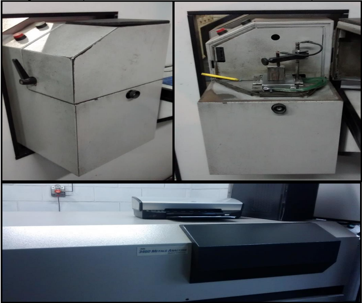
Figura 26 - Espectrômetro de Emissão Ótica utilizado na análise química.
