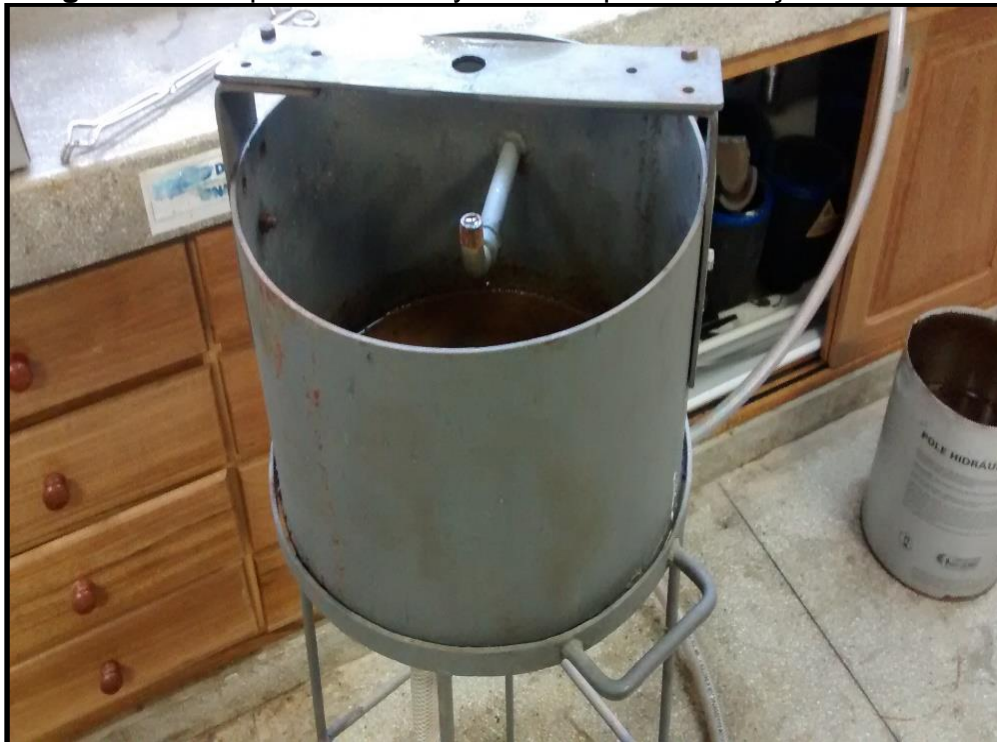
Figura 39 - Dispositivo Jominy utilizado para realização do ensaio.
