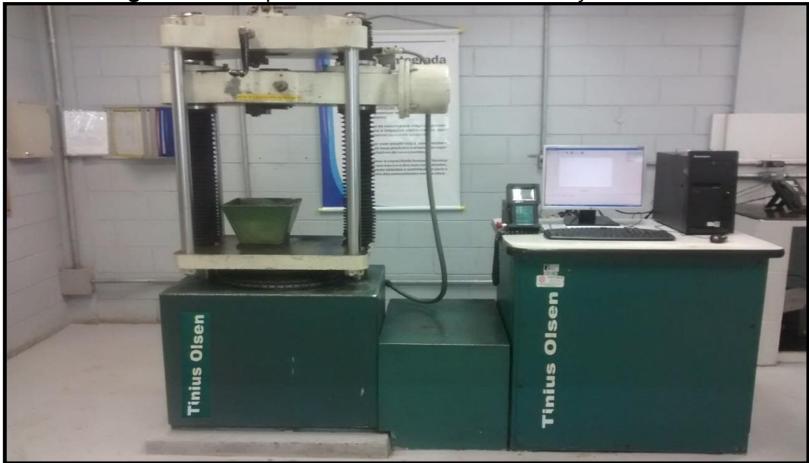
Figura 35 - Máquina universal de ensaio de tração utilizada.
