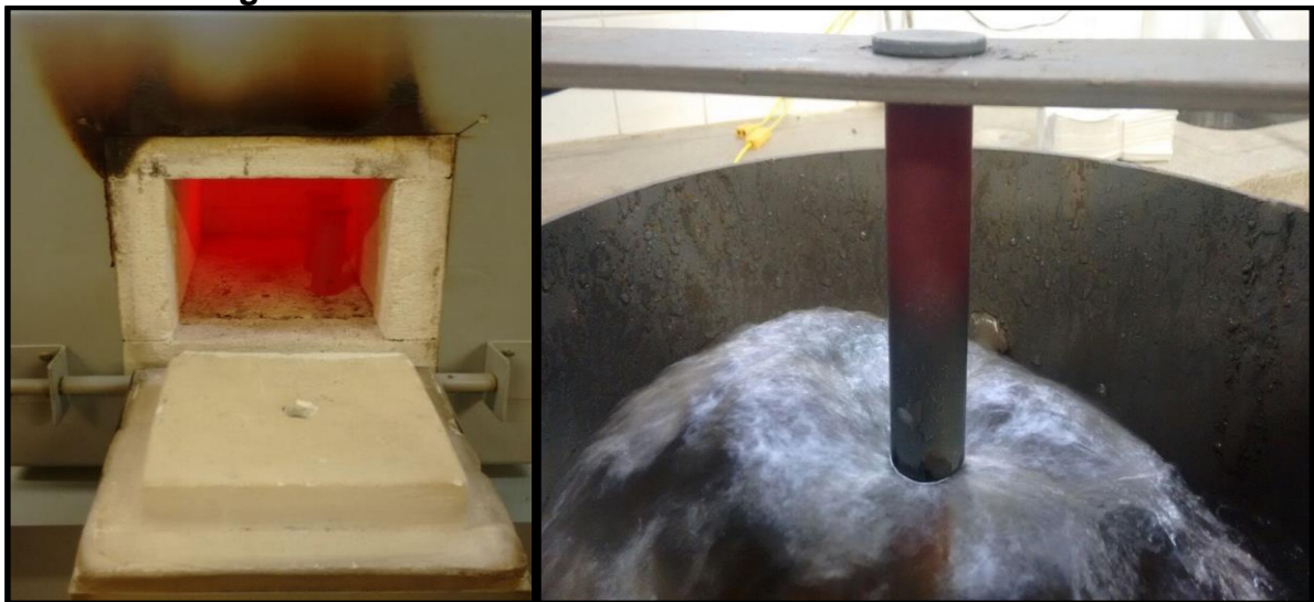
Figura 50 – CP's no forno mufla e CP's sendo ensaiados.
