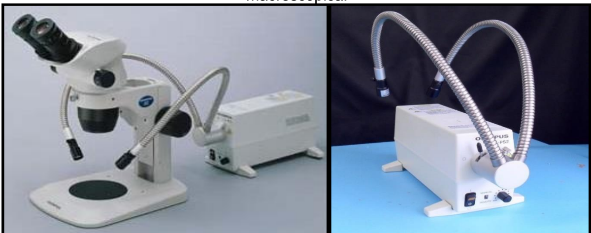
Figura 31 - Microscópio estéreo e unidade de fonte de luz utilizados na análise macroscópica.
