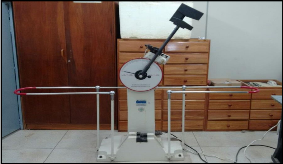
Figura 33 - Máquina de ensaio de impacto utilizada.
