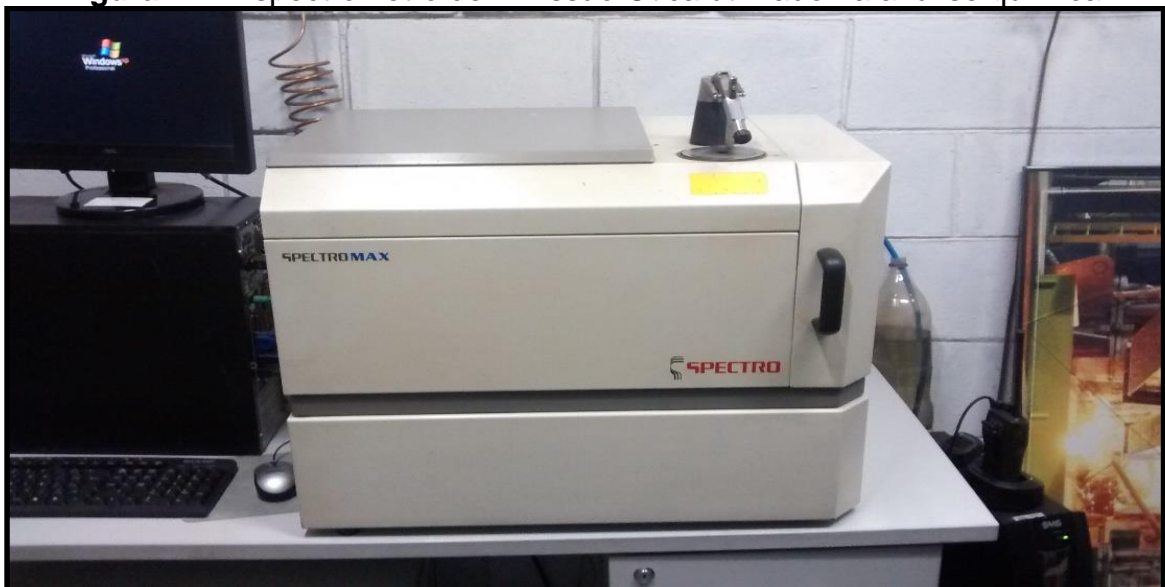
Figura 27 - Espectrômetro de Emissão Ótica utilizado na análise química.
