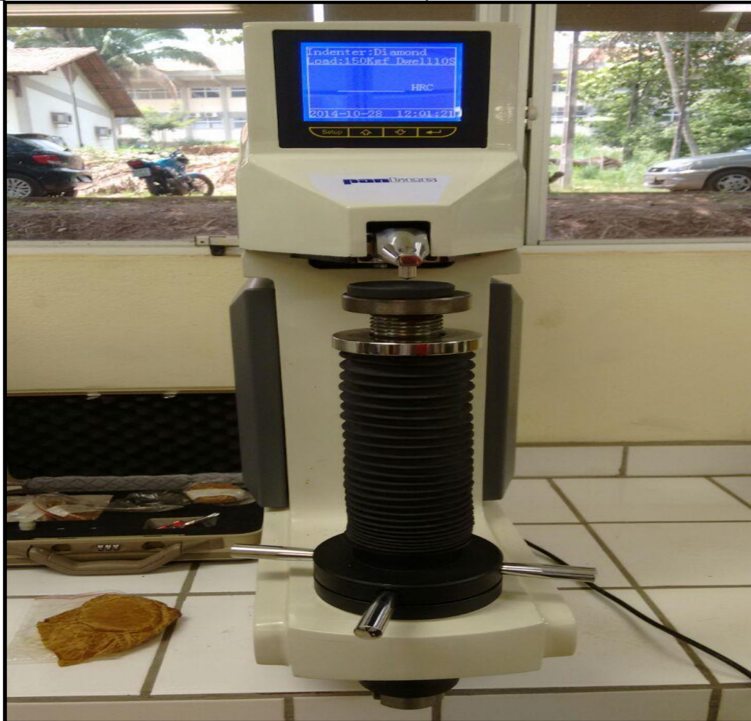
Figura 32 - Durômetro de bancada utilizado para medida de dureza Rockwell C.
