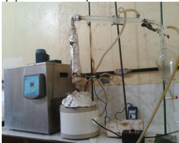
Figura 28: Equipamento de destilação fracionária com isolantes térmicos.
