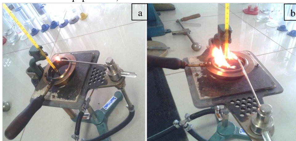
Figura 25: Equipamento de determinação do Ponto de Fulgor a - Modelo de equipamento, b - Momento de combustão de um material
