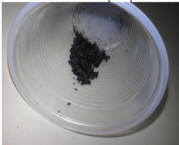
Figura 29: Resultado da amostra após aquecimento a 410°C.
