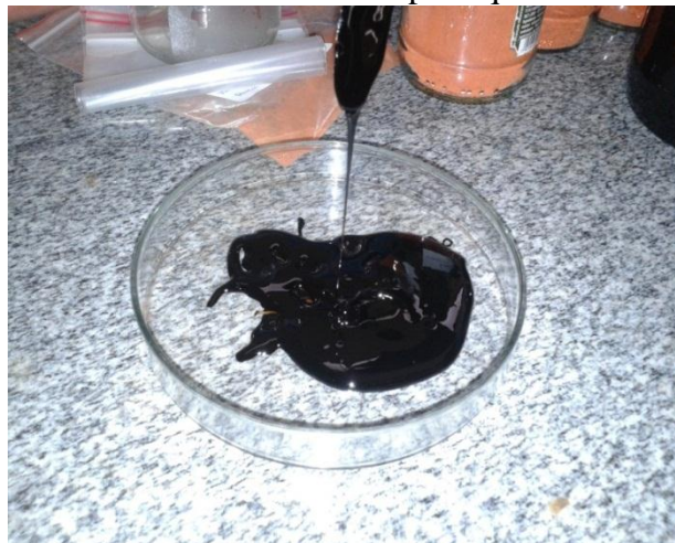
Figura 30: Resultado da amostra após aquecimento a 375°C.
