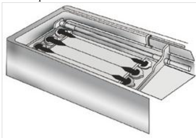
Figura 26: Esquema de Ensaio de Ductilidade em andamento
