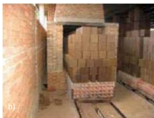
Figura 7- Fornos utilizados na queima dos blocos. a) Forno intermitente (abóboda); b) Forno contínuo (túnel)
