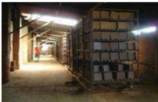
Figura 5- Secagem natural de blocos cerâmicos
