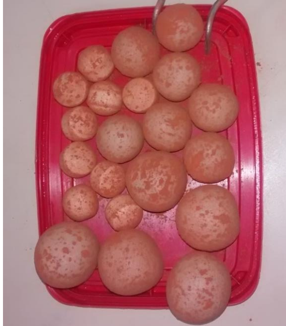
Figura 8 – Bolas de Alumina utilizadas na desaglomeração da Lama Vermelha.
