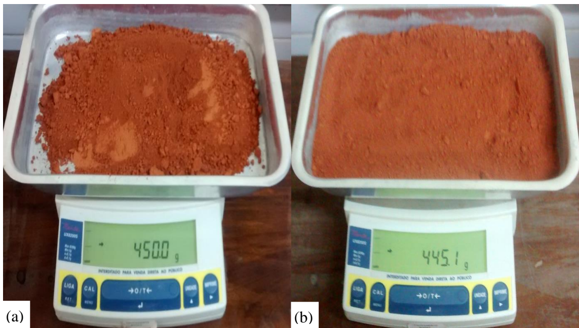
Figura 23 – Lama vermelha (a) antes da secagem e (b) depois da secagem.
