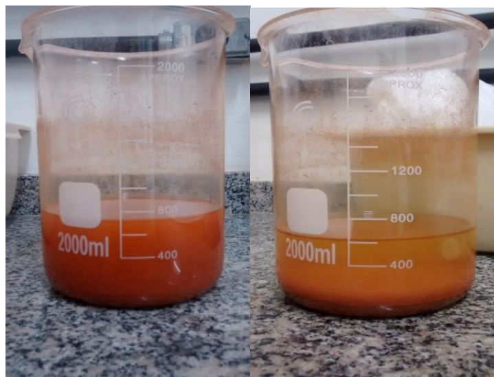
Figura 13 – Decantação da Lama Vermelha (a) início do processo, (b) término do processo.
