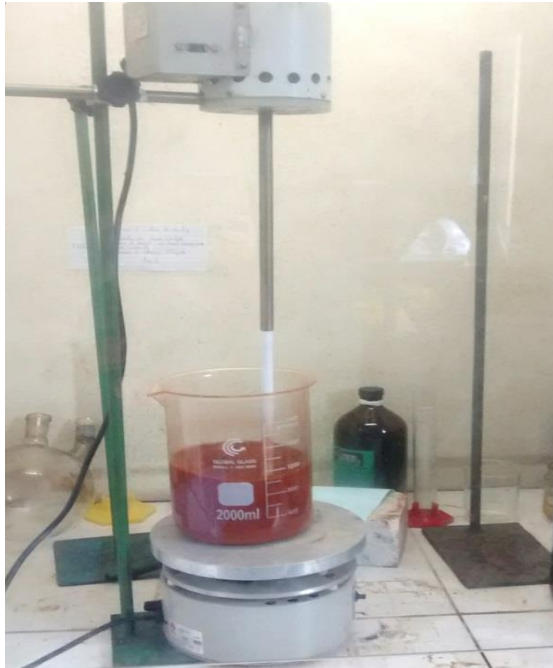
Figura 12 – Agitação da solução de Lama Vermelha e ácido clorídrico.
