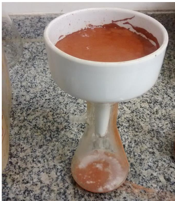
Figura 18 – Filtração da Lama Vermelha em funil de Büchner.
