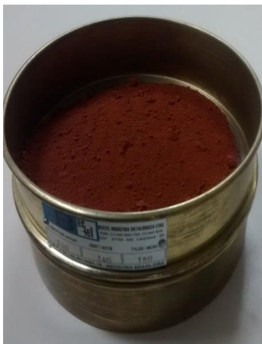
Figura 10 – Classificação granulométrica da Lama vermelha através do peneiramento.
