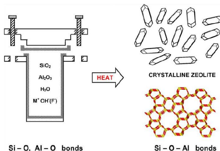
Figura 17 - Síntese hidrotérmica de zeólitas.
