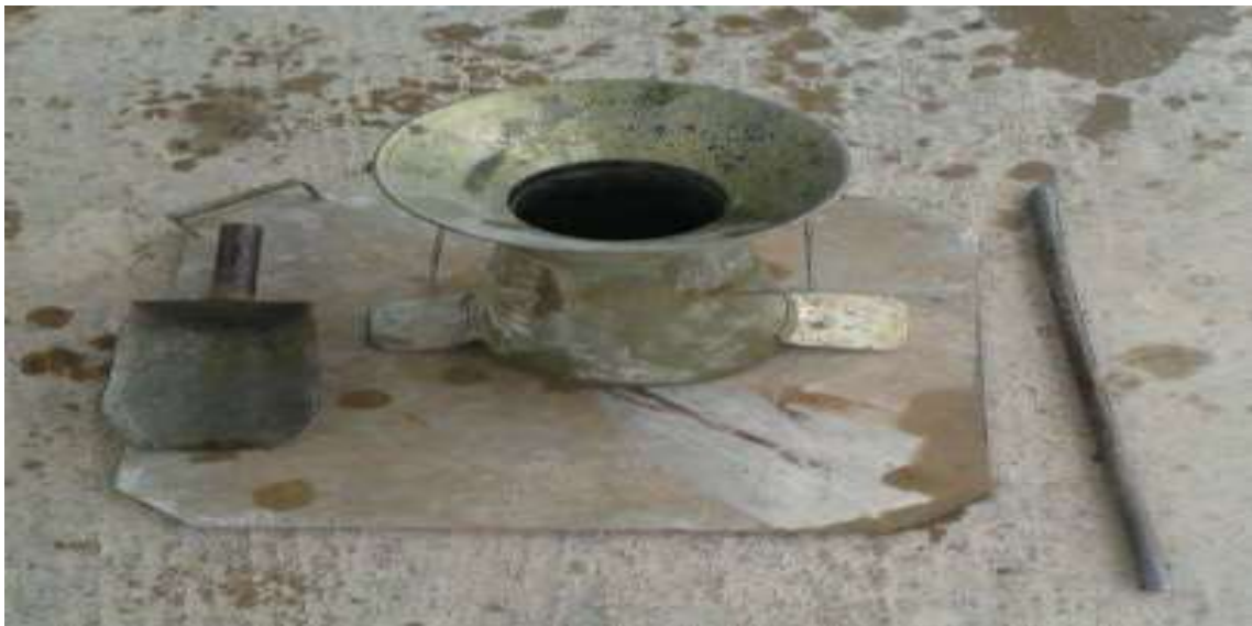
Figura 5 - Ensaio de abatimento de tronco
