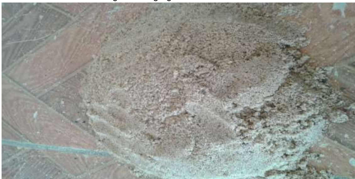
Figura 7 - Agregado miúdo utilizado.
