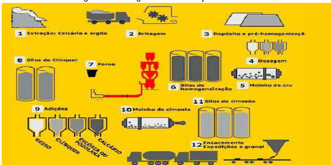
Figura 1 : Fluxograma da fabricação do cimento
