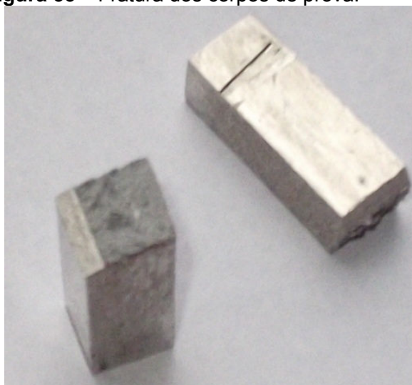
Figura 33 – Fratura dos corpos de prova.
