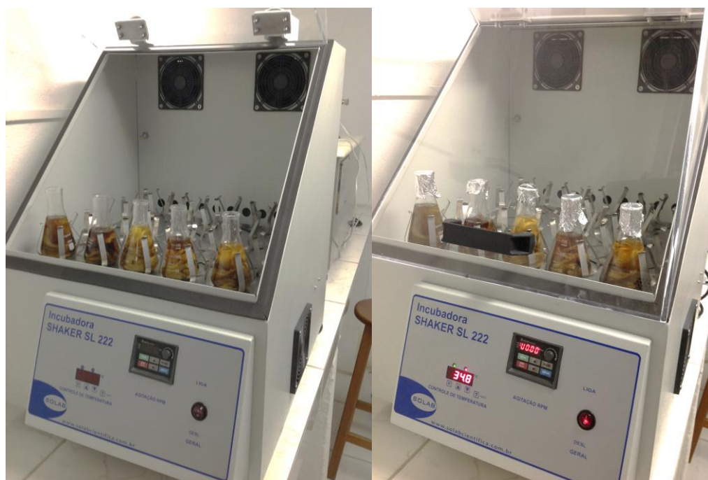
Figura 14: Fibras durante o processo químico com hidróxido de sódio (NaOH).
