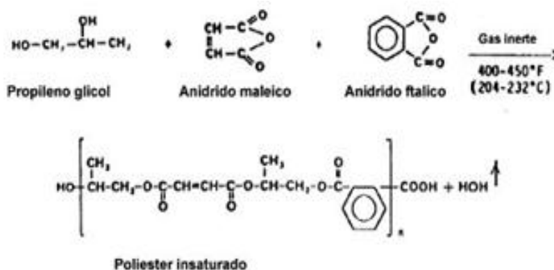
Figura 03: Representação da reação de obtenção do poliéster insaturado.
