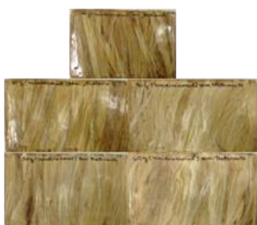
Figura 18 (c): Placas com fibras tratadas com 3% NaOH
