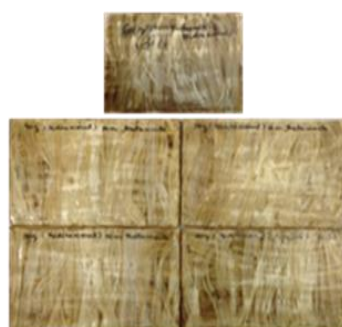
Figura 18 (d): Placas com fibras tratadas com 5% NaOH
