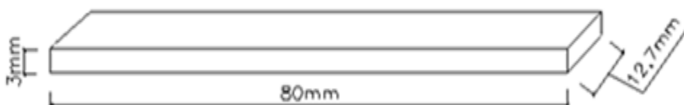
Figura 19: Dimensão do corpo de prova para ensaio de flexão.
