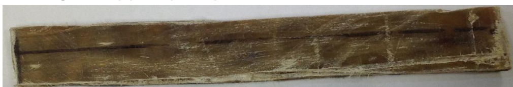
Figura 17 (b): Corpo de prova com fibras tratadas com NaOH
