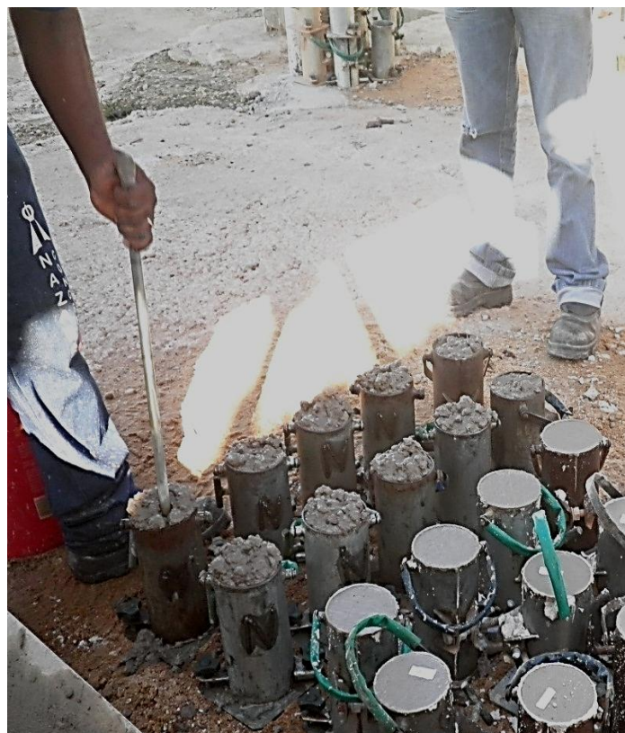
Figura 10: Confecção dos corpos-de-prova. Fonte: autora.
