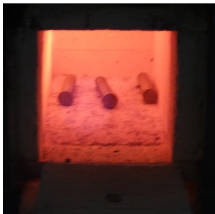
Figura 17: Corpos de prova assim que inseridos no forno, na temperatura de austenitização
