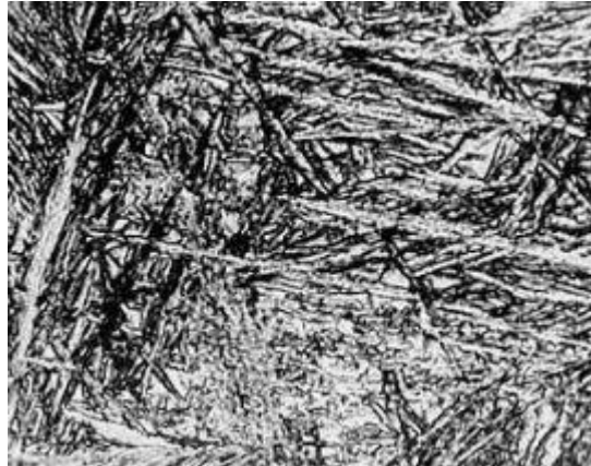
Figura 4: Apresentação da estrutura martensítica de um aço vista ao microscópio.
