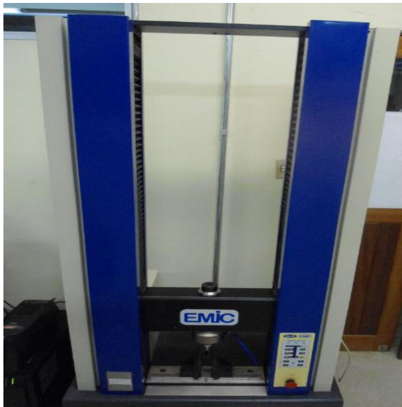
Figura 4.3.1.1 - Máquina de ensaio universal EMIC DL 10000, utilizada para o ensaio de flexão.
