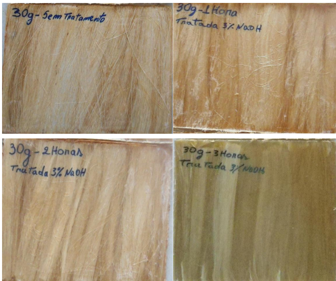
Figura 4.2.2.2 – Placas dos compósitos estudados, orientadas unidirecionalmente.
