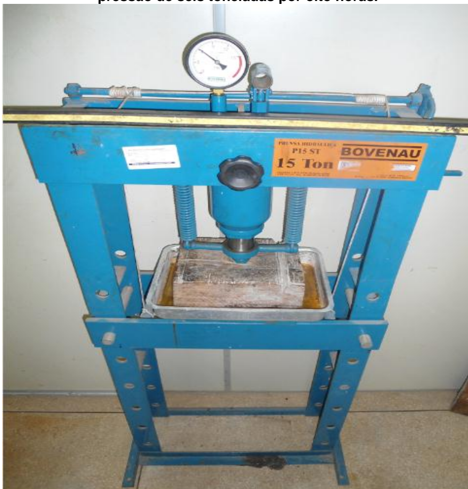
Figura 4.2.2.1 - Placa sendo confeccionada em uma prensa hidráulica sob pressão de seis toneladas por oito horas.
