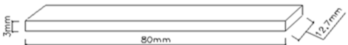
Figura 4.3.1 – Dimensão do corpo de prova para ensaio de flexão.
