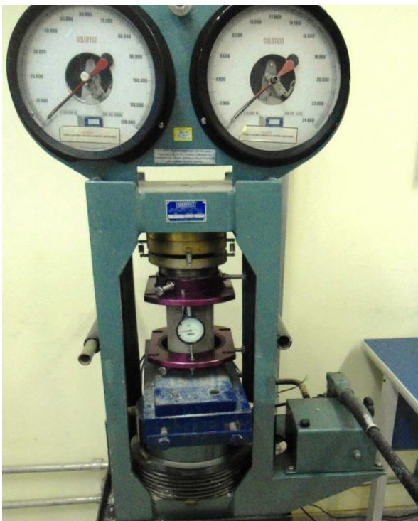
Figura 11 – Ensaio de compressão
