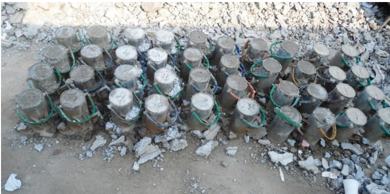
Figura 9 – Corpos de prova nos moldes.
