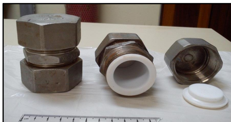
Figura 13 - Autoclave de aço inoxidável utilizada nos processos de síntese
