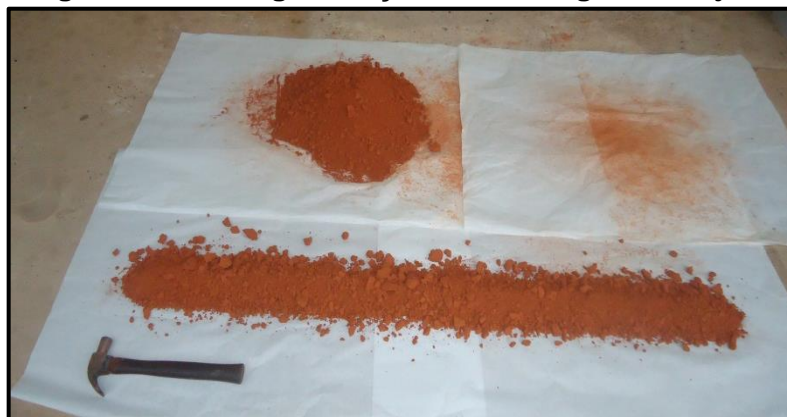
Figura 12 - Homogeneização e amostragem do rejeito
