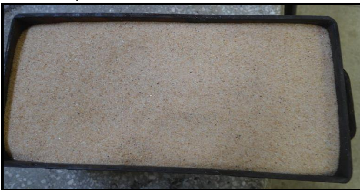
Figura 16- Amostras cobertas com camadas de carvão e sílica.
