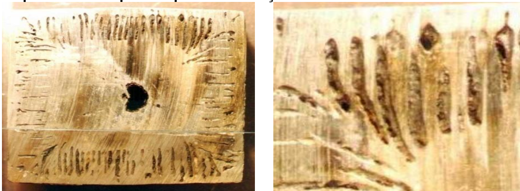
Figura 2.12: À esquerda seção transversal de tarugo com blowholes e a direita seção próxima da superfície para visualização das características do defeito.
