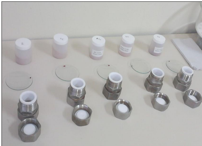
Figura 7 : Reatores de aço inoxidável utilizado nas sínteses
