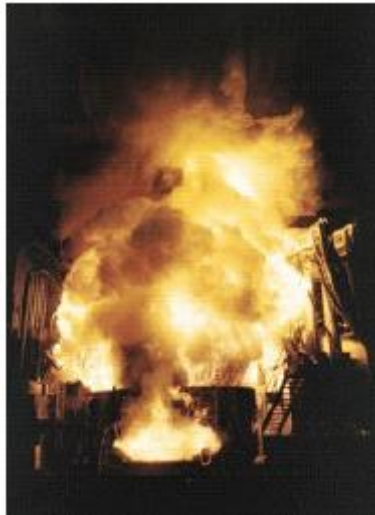
Figura 2- Emissão de fumos durante o vazamento de aço em forno elétrico.
