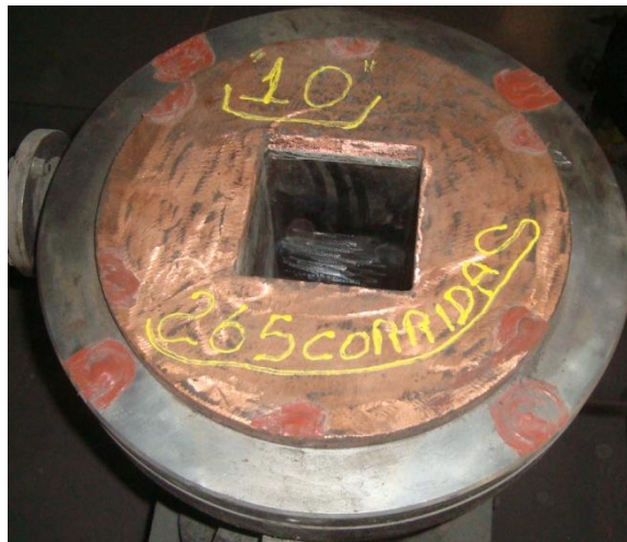
Figura 10 – Molde desgastado para análise
