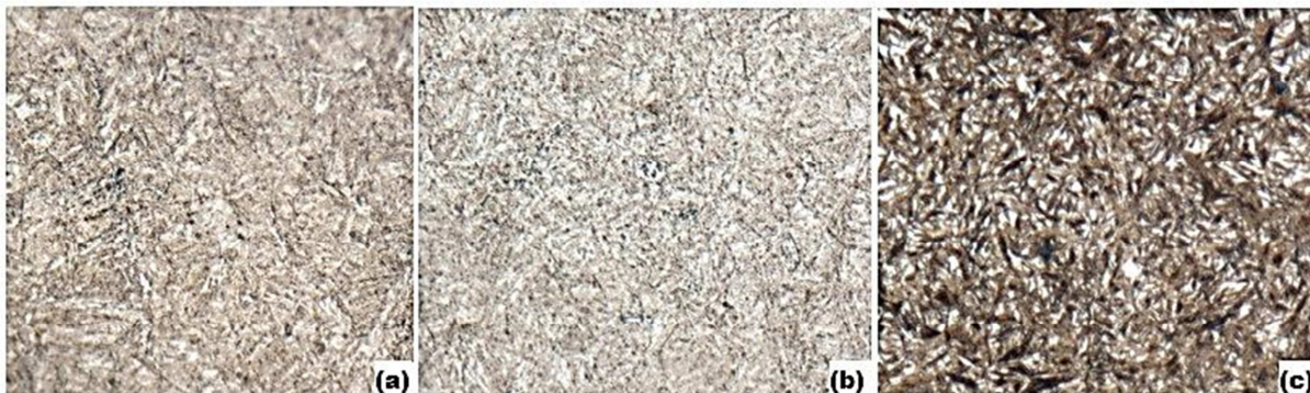
FIGURA 18 – Metalografia CP4 Aumento 1000x (a) borda interna, martensita; (b) região intermediária, austenita com perlita; (c) borda externa, martensita com austenita retida.
