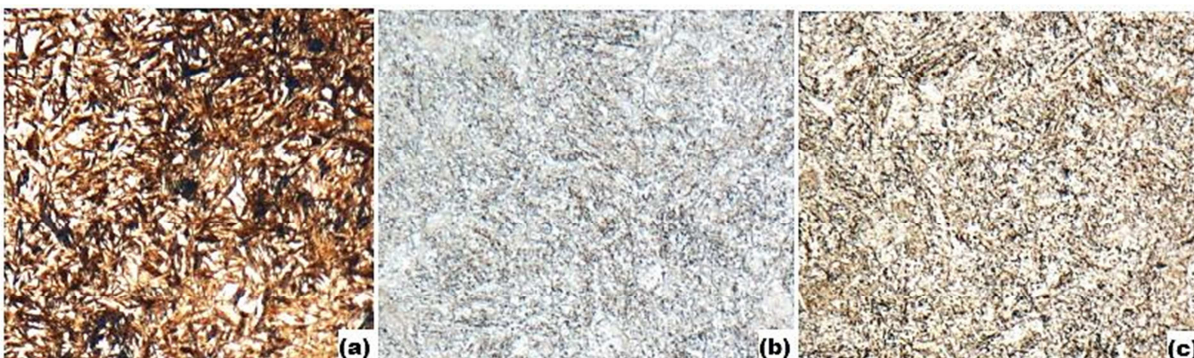
Figura 19 – Metalografia CP5 Aumento 1000x (a) borda interna, martensita com austenita retida; (b) região intermediária, austenita; (c) borda externa, martensita.
