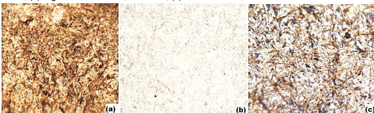
FIGURA 17 – Melatografia CP3 Aumento 1000x (a) borda interna, martensita com austenita retida; (b) região intermediária, austenita; (c) borda externa, martensita com austenita retida.
