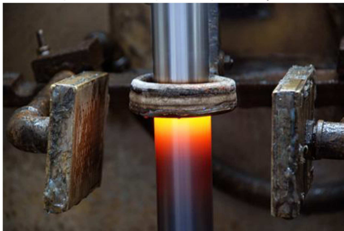
FIGURA 07 – Aquecimento superficial por indução, austenitização.
