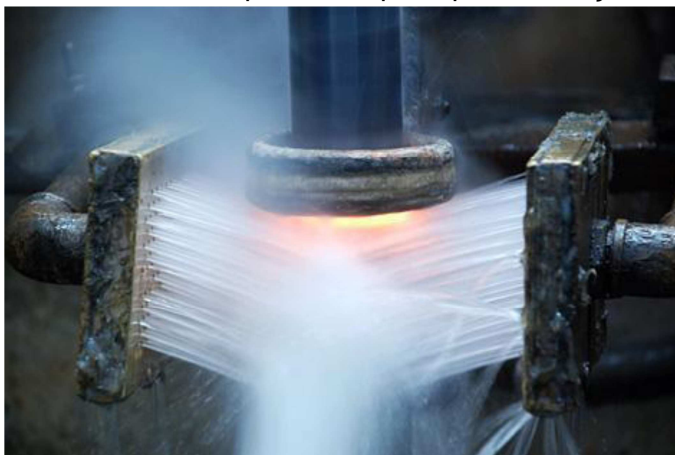
FIGURA 08– Resfriamento superficial rápido, para obtenção da martensita.
