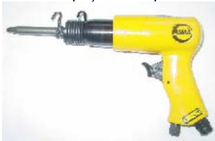
Figura 16: Martelo de punção com uma ponteira deformável
