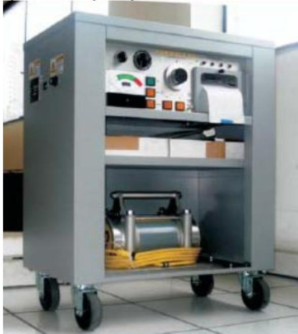
Figura 17: Equipamento típico para alívio de tensões por vibrações
