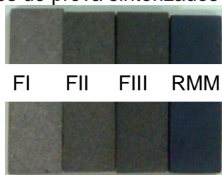
Figura 13 – Corpos de prova sinterizados a 1200°C
