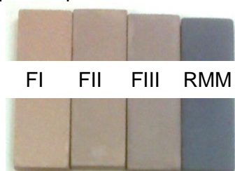
Figura 11 – Corpos de prova sinterizados a 1000°C
