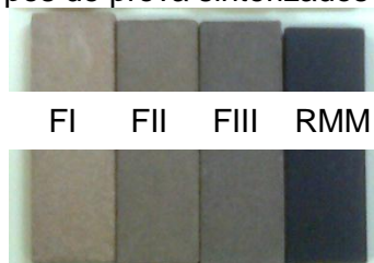
Figura 13 – Corpos de prova sinterizados a 1200°C
